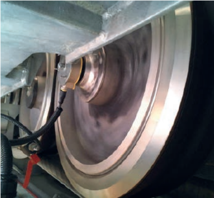
Der QR24-Drehgeber zählt die Umdrehungen der Hohlkehlrollen und sendet die Daten an eine Steuerung.
