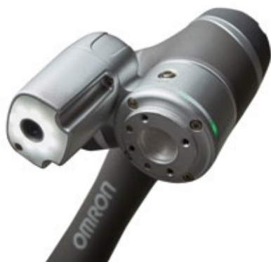
Die TM-Roboter verfügen über ein integriertes intelligentes Bildverarbeitungssystem.
