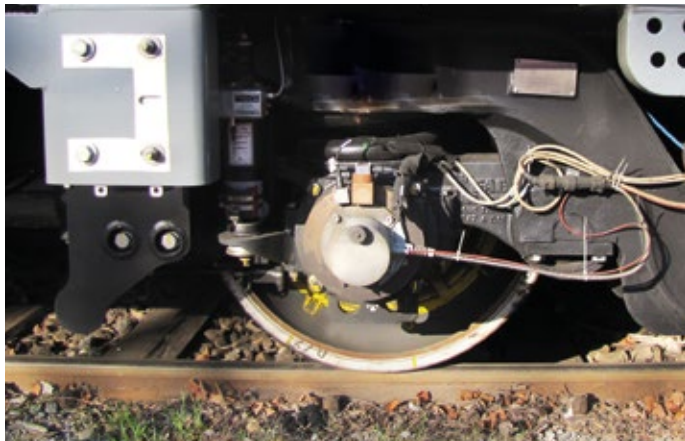
Für die Messungen werden die ASC-Sensoren an den Radsätzen der Züge montiert.
