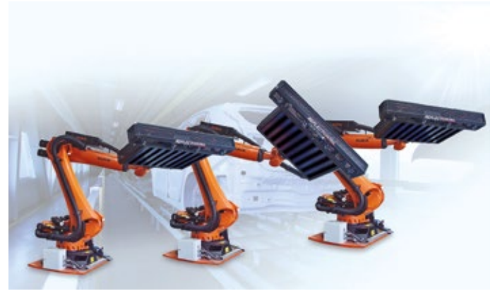
Monitor und Kameras sind in einem leichten Gehäuse aus Carbon untergebracht, der Sensorkopf kann dadurch vom Roboter sehr dynamisch bewegt werden.
