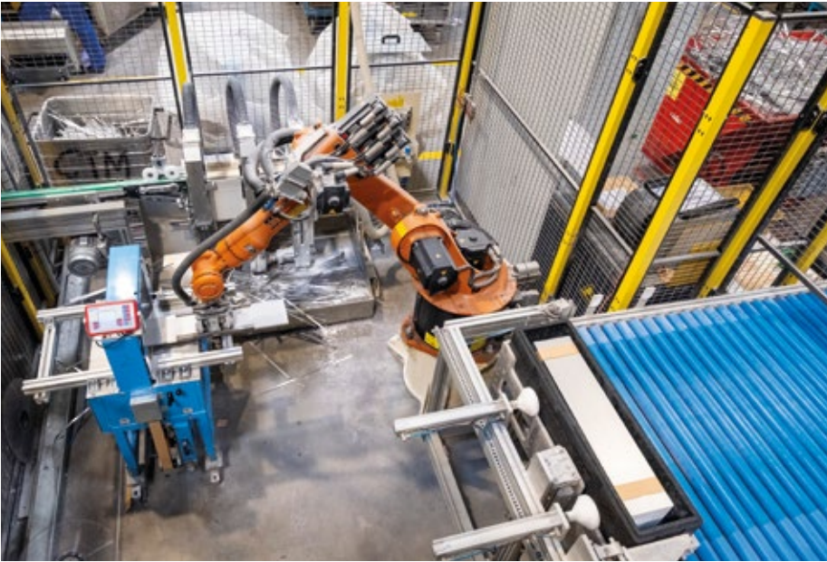
Ein Roboter entnimmt die fertigen Kühlerröhrchen, bündelt sie und leitet sie in die weitere Montage.
