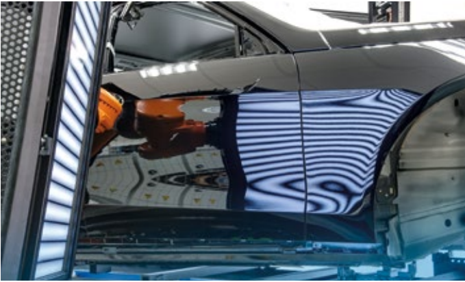
Bei der Deflektometrie werden spiegelnde Oberflächen mit der Projektion eines Streifenmusters auf Fehler geprüft.
