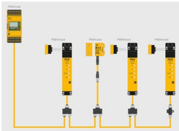
Mit der Diagnose-Lösung Safety Device Diagnostics lässt sich das bewährte Prinzip der Reihenschaltung jetzt auch in einer kostengünstigen Linienverkabelung mit Sicherheitsgeräten verschiedener Hersteller umsetzen.
