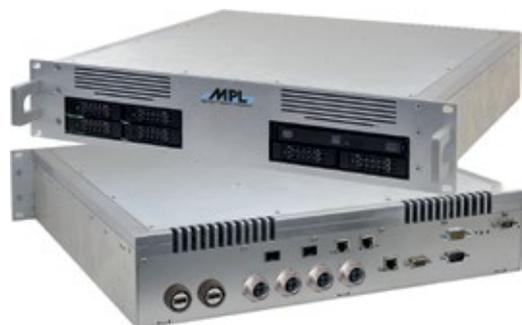
Der neue lüfterlose Xeon-Server von MPL eignet sich für anspruchsvolle Umgebung, wie zum Beispiel den Bahnbereich. Der Server ist in einem 19"-Gehäuse installiert und kann nach Kundenwünschen konfiguriert werden. Das Konzept bietet mehr Rechenleistung, mehr
