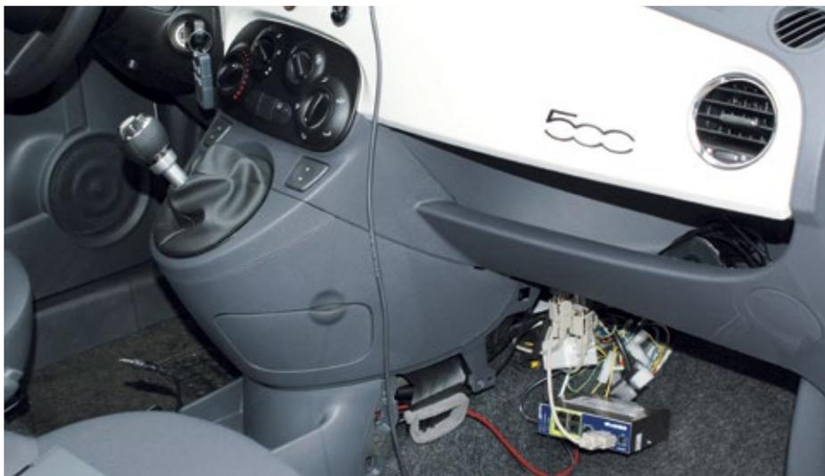
Die Fernwartungsrouter eWon werden im Fiat hinter der Verkleidung im Fußraum des Beifahrers untergebracht.
