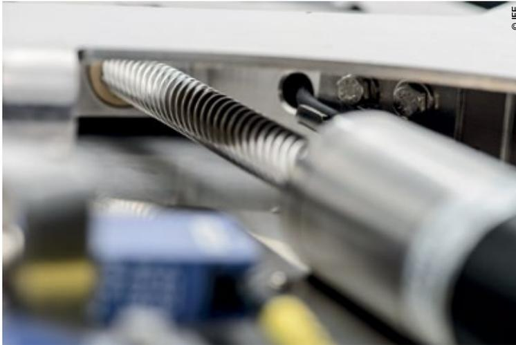
Bei dem Schiebetritt handelt es sich um ein zuverlässiges System. Zentraler Bestandteil der Lösung sind wartungs- und schmiermittelfreie Steilgewindespindeln und Steilgewindemuttern von Iigus.
