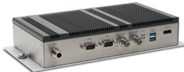
übertragung lassen sich die Computer mit GPS- und LTE/GSM/UMTS-Funktionen ausstatten. Die Anbindung an bahntypische Bus-Systeme wie Realtime Ethernet, TCN, WTB, ProfiNET oder MVB erfolgt über optionale Erweiterungskarten, die sich einfach integrieren lassen. [www.syslogics.de](http://www.syslogics.de)
