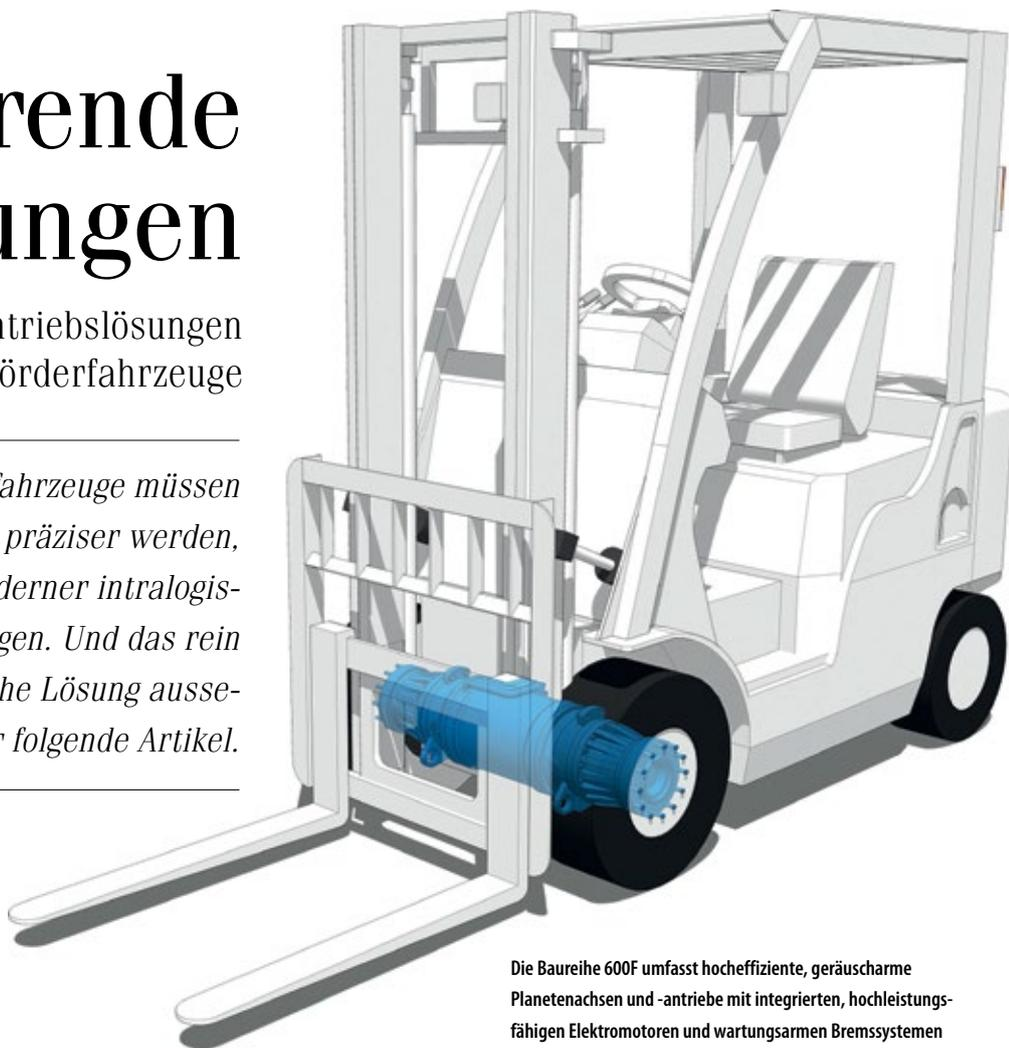
Die Baureihe 600F umfasst hocheffiziente, geräuscharme Planetenachsen und -antriebe mit integrierten, hochleistungsfähigen Elektromotoren und wartungsarmen Bremssystemen für Flurförderfahrzeuge der Klasse 1.
