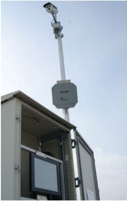
Sende- und Empfangsantenne von Balluff, darüber das Kamerasystem, um die Ladung zu fotografieren.
