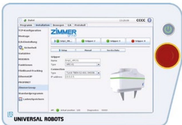
Ansteuerung der Zimmer-Komponenten über die Bedienoberfläche von Universal Robots
