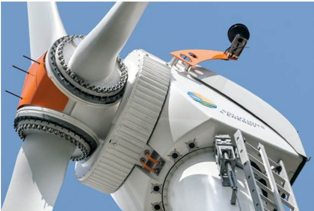
Der Windkraftgenerator DSHT-650 von Baumüller sitzt direkt hinter den Rotorblättern und wird über die Kühlrippen ausschließlich durch den Luftstrom der Rotorblätter gekühlt.
