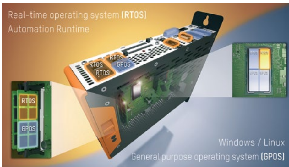
Der RTS-Hypervisor ermöglicht eine eindeutige Zuordnung aller Hardware-Ressourcen eines Industrie-PCs.
