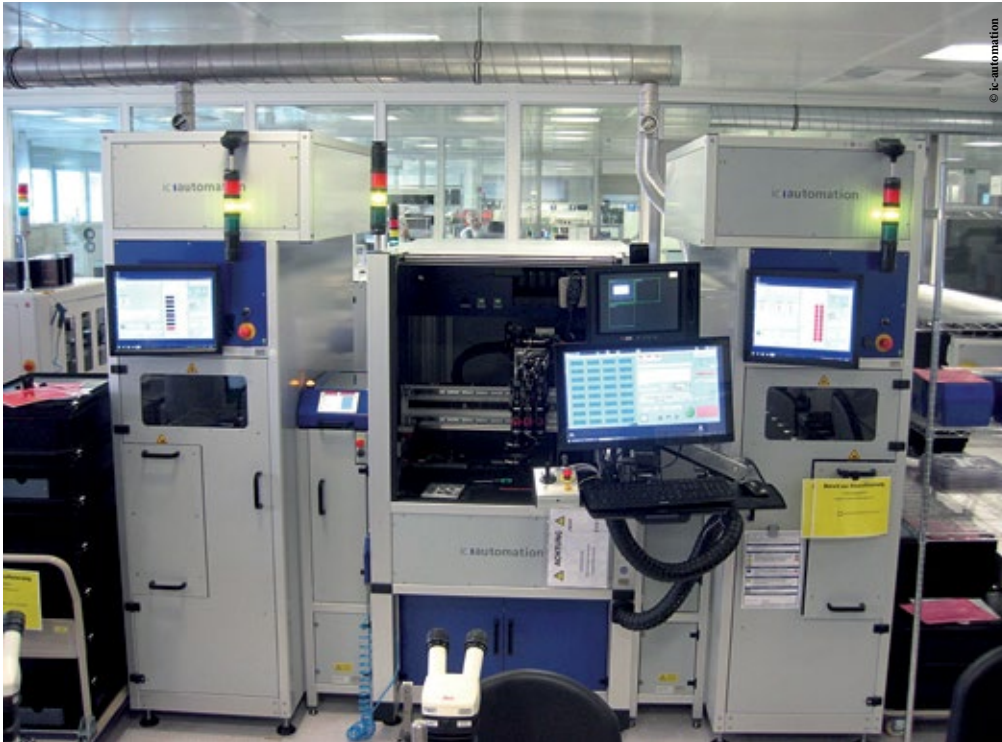
Da der Platz in der Reinraumproduktion teuer ist, sollten die Anlagen möglichst kompakt stehen. Der Hochstapler von Ic-automation ermöglicht die optimale Ausnutzung der Fläche.
