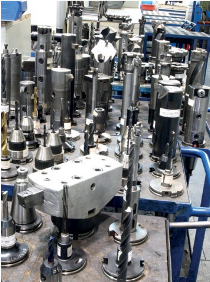
Tool-ID: Vorbereitete Werkzeuge in einer Werkzeugvoreinstellung – in dem Unternehmen gibt es insgesamt rund 10.000 technologisch und geometrisch unterschiedliche Werkzeuge, die mit RFID-Technologie einfach zu handhaben sind.
