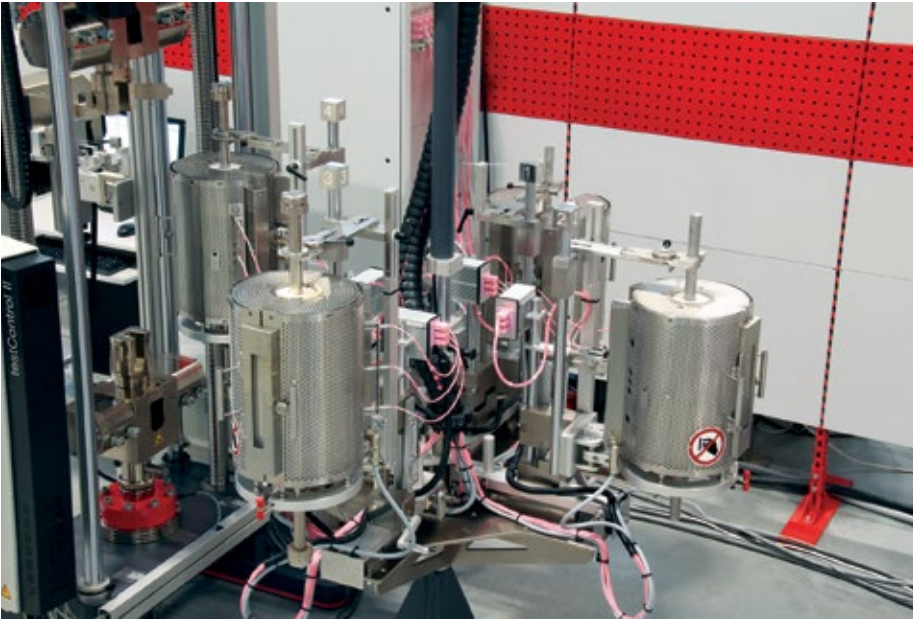
◀ Hochtemperaturanlage mit Mehrfach-Ofen
