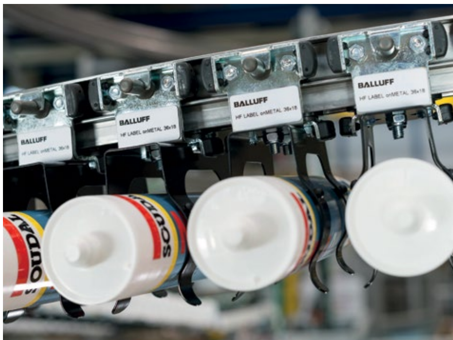
Selbstklebende Balluff-OnMetal-RFID-Tags erlauben eine sehr flache Kennzeichnung der Shuttles.
