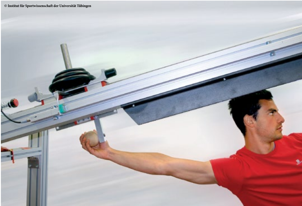
Die Analyse der Wurfbewegung erfolgt auf Basis einer Positionsmessung mit einem drei Meter langen magnetostriktiven Sensor vom Typ MK4 der Firma Gefran.
