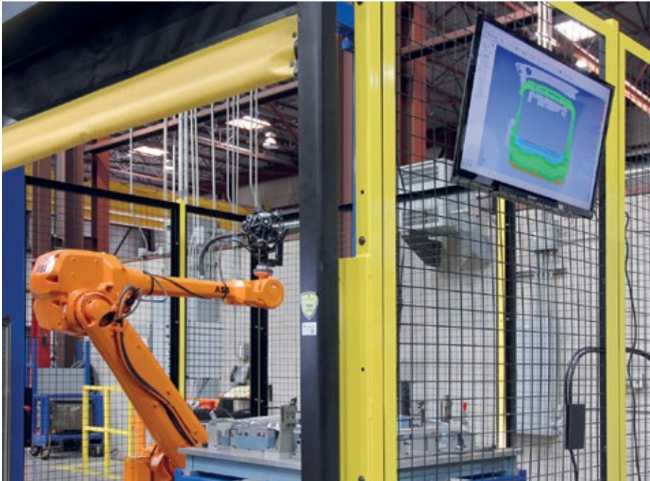
Automatisierte Qualitätskontroll-Lösung, die optische Reflektoren zur Durchführung genauer und wiederholbarer Messung im Fertigungsbereich einsetzt.
