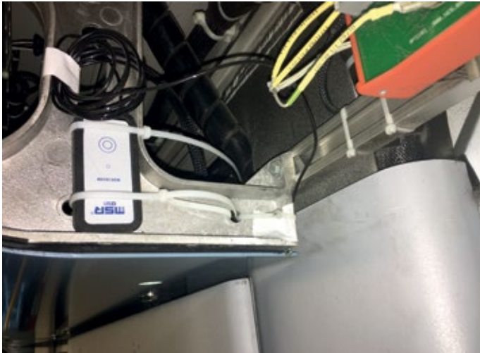
Sensor-/Funkmodul als Temperaturfühler im Innenraum der Straßenbahn
