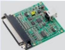
USB-4702 10 kS/s, 12 Bit, 8-Kanal USB-Multifunktionsmodul
