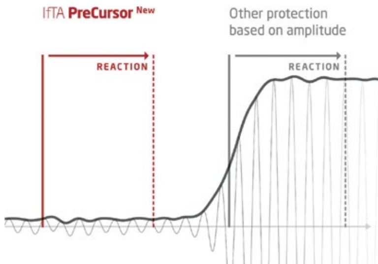
Der IFTA-PreCursor warnt vor Verbrennungsschwingungen, bevor diese kritische Amplituden erreichen. Somit bleibt genügend Zeit, um rechtzeitig zu reagieren.
