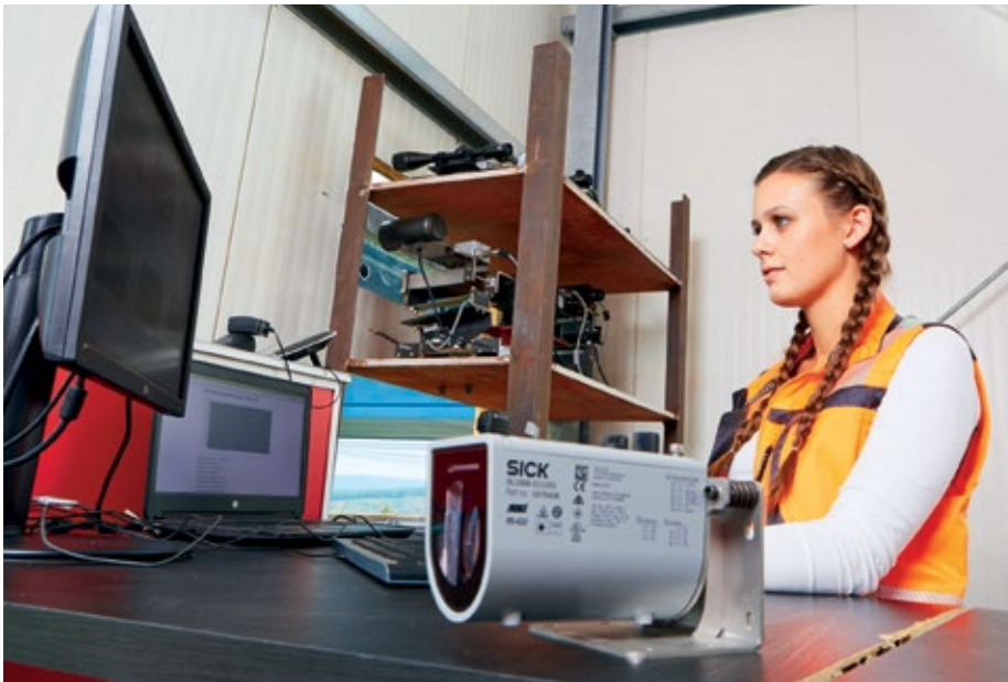
Studentin Verena Franzen kontrolliert die Messwerte der Distanzsensoren während des Verschubs in Echtzeit.
