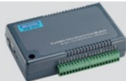
USB-4704 48 kS/s, 14 Bit, 8-Kanal USB-Multifunktionsmodul
