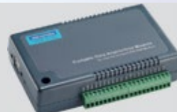
USB-4750 32-Kanal Digital-I/O-USB-Modul
