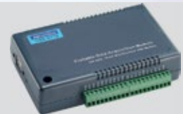
USB-4716 200 kS/s, 16 Bit, 16-Kanal USB-Multifunktionsmodul
