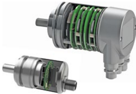
16-Bit Drehgeber im Vergleich – Optik vs. Magnetik: Reduktion von Größe und Gewicht um bis zu 50 Prozent – erreicht vor allem durch den Wegfall der bei optischen Drehgebern notwendigen Getriebesysteme für Multiturn-Einsätze.
