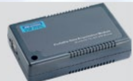
USB-4751/L 24-/48-Kanal Digital-I/O-USB-Modul
