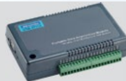
USB-4711A 150 kS/s, 12 Bit, 16-Kanal USB-Multifunktionsmodul
