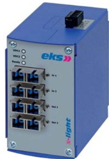
Der optische Bypass X-light wird über zwei Duplex-Ein- und -Ausgänge mit dem Netzteilnehmer parallel geschaltet. Fällt dieser aus, wird er physikalisch überbrückt.
