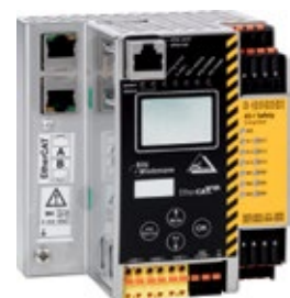
Das AS-i-FSoE-Gateway BWU3509 agiert als Safety Master und kann ohne zusätzliche sichere Steuerung sicherheitstechnische Aufgaben übernehmen.
