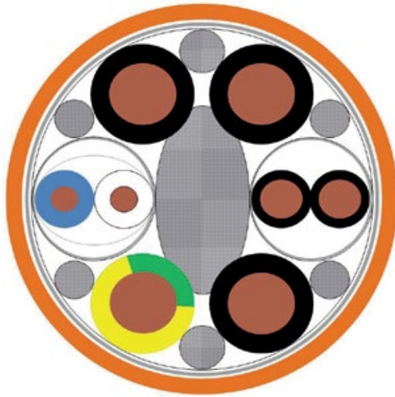
Typischer Leitungsaufbau eines Hybridkabels: drei schwarze Leistungsadern, GN/GE Schutzleiter, optionales Steuerpaar mit Abschirmgeflecht (schwarz), Signalpaar mit alukaschierter Folie und Abschirmgeflecht (weiß/blau)
