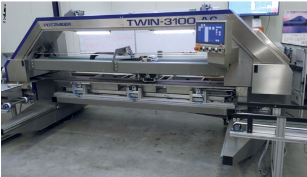
◀ Vollautomatische Schleifanlage mit automatischer Zu- und Abfuhr der Waschbecken
