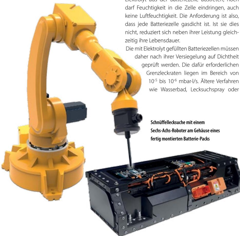
Schnüffellecksuche mit einem Sechs-Achs-Roboter am Gehäuse eines fertig montierten Batterie-Packs
