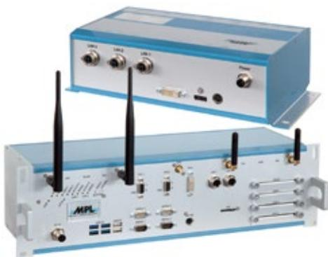
Das Unternehmen MPL baut seine Produktpalette an Railway-Computern weiter aus und stellt hierfür jetzt den Rail-Pip39 – eine i7-Quad-Core-Lösung – vor. Der neue Embedded-Computer basiert auf dem Pip39, der bereits für Anwendungen in rauen und harten Umgebungen eingesetzt wird. Bei der Temperaturmessung entschied sich
