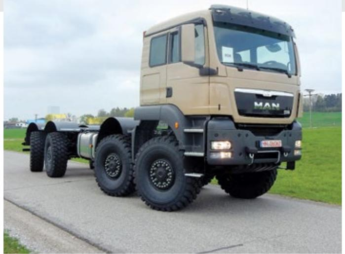
Jede Achse ist einzelbereift, gelenkt und angetrieben.
