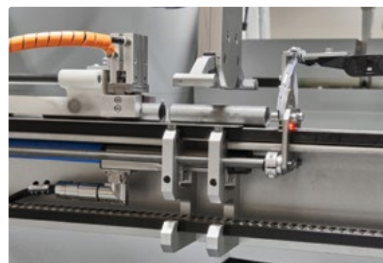
Greifermodul vor der Übernahme des abgetrennten Rohrsegments
