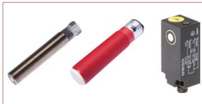
Die Ultraschalltaster (I. Gewindegerte) sind in einem Temperaturbereich von -25 °C und +70 °C einsetzbar. Die Schaltabstände reichen von 200 mm bis 6 m. Rechts eine Ultraschallreflexschranke für einen Temperaturbereich von -10 °C bis +60 °C.
