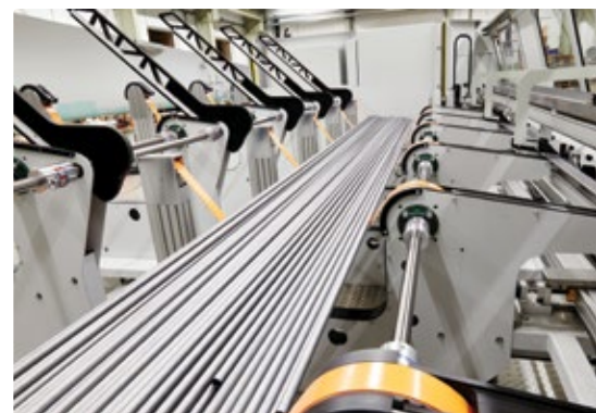
Rohrspeicher mit Antriebsbändern, rechts das Schrägbettmagazin mit Zuführung
