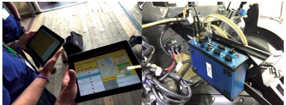
Das technische Team konfiguriert und überwacht die Transponder (Blaue Box, r.) in den Fahrzeugen mittels Webservice (l.). ►
