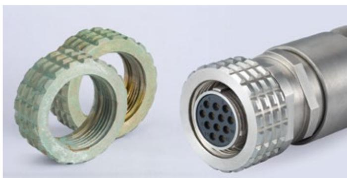
Die Rundsteckverbinder aus ARCAP weisen eine gute Korrosionsbeständigkeit auf. Selbst 1.000 Stunden Salznebel zeigen kaum Wirkung.
