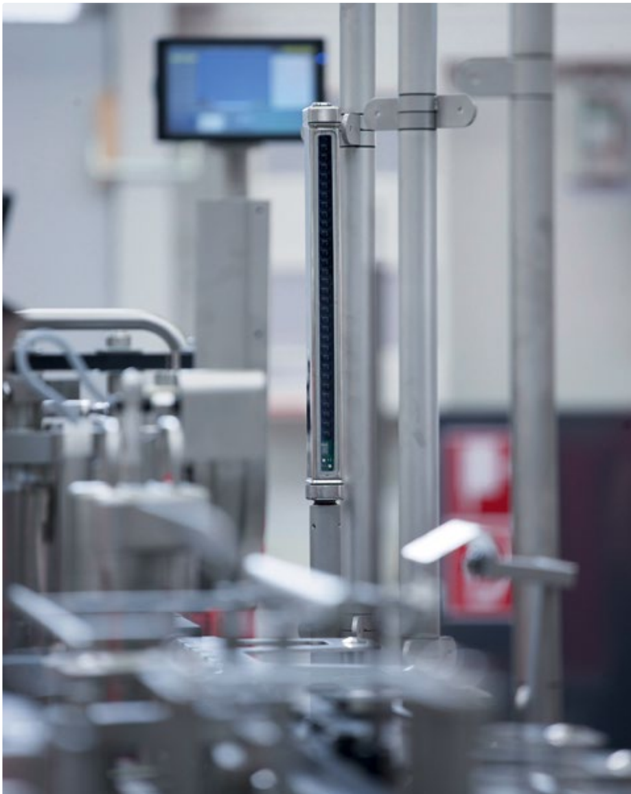
Unscheinbar: Die Sicherheitslichtvorhänge fügen sich mit ihrer schmalen Bauform nahtlos in die Maschine ein.
