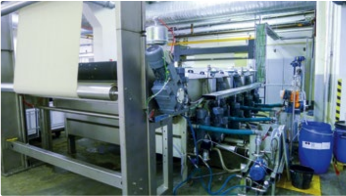
Getriebemotoren von Lenze treiben die Siebtrommeln und die SplashRoller an.
