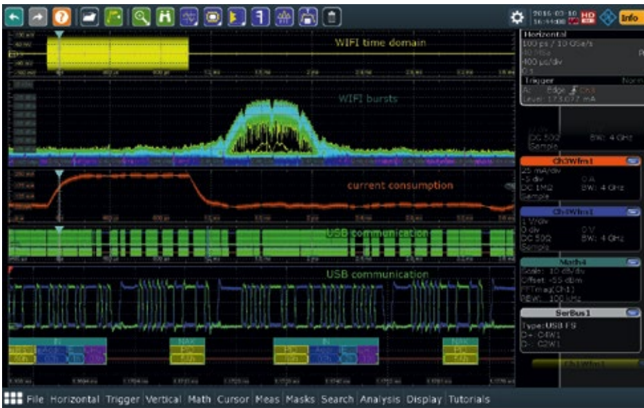
Beispiel einer Multi-Domain-Anwendung des neuen Oszilloskops von Rohde & Schwarz – IoT-Baustein mit WiFi-Funkmodul, batteriebetriebener Stromversorgung und USB-Schnittstelle.
