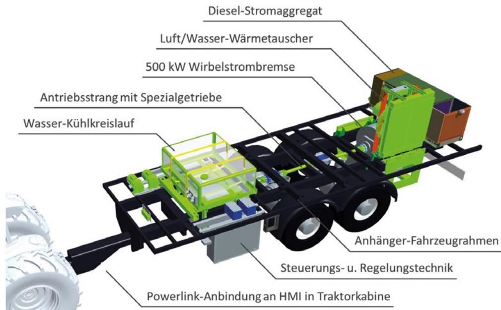
Für die Kommunikation mit dem Bremsfahrzeug setzt Enders auf Powerlink und ermöglicht so dem Messtechniker in der Fahrerkabine direkten Zugriff auf alle relevanten Messgrößen.
