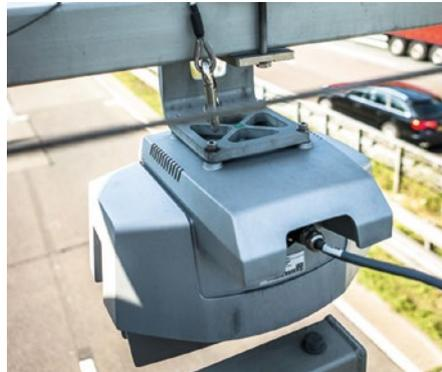
Der Han 3 A ist wasserdicht nach IP65/67, UV-beständig und mit einem stabilen Zink-Druckguss-Gehäuse ausgestattet.
