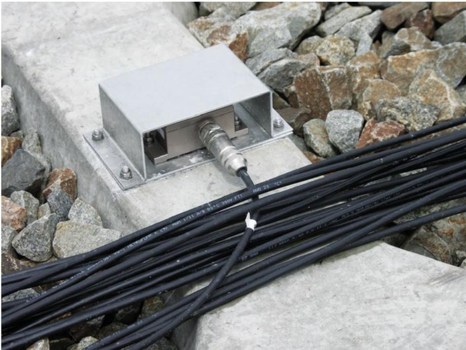
◀ Die Sensoren sind durch ein Blech gegen Steinschlag und direkte Sonneneinstrahlungen geschützt, und über PUR-Kabel wurden die Stromschnittstellen mit dem Datenlogger-System verbunden.
