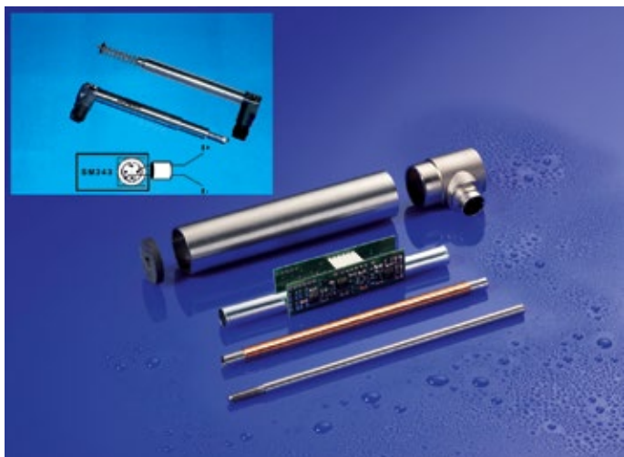
Symmetrischer Aufbau von induktiven Wegaufnehmern
