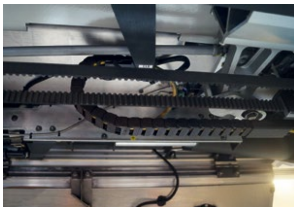
Die Chainflex-Leitung CFSpecial.414 wird in kompakten Energieketten der Serie E2.15 sicher bewegt.
