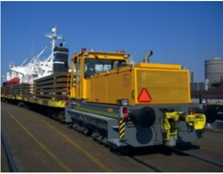
Die Zweibege-Rangierlok von TransLok im Hafenbetrieb von Sydney. Ein Drehgeber dient als Rückmelder für die Lenkung.
