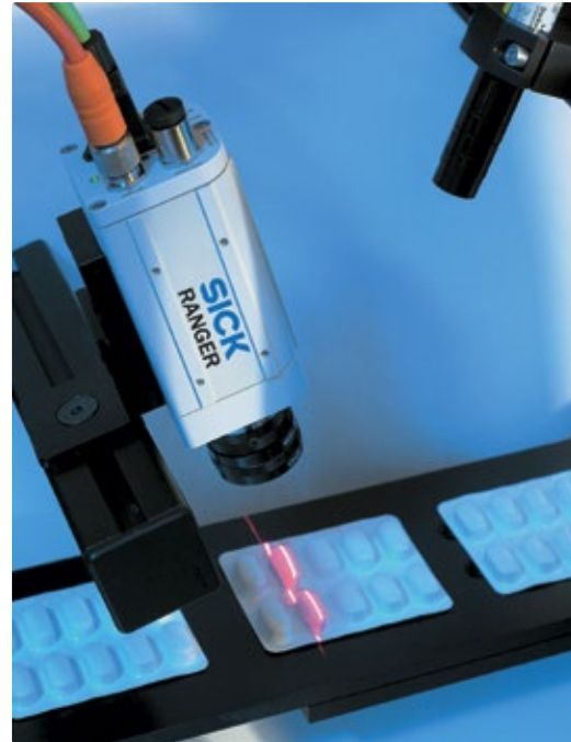
3D-Vision eignet sich gut zur Analyse von Formen, Volumen oder der 3D-Position von Objekten.
