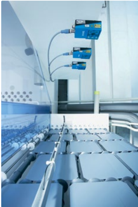
Bei Applikationen, in denen es um die Erfassung eines hohen Kontrasts oder die Struktur beziehungsweise Farbe von Objekten geht, spielen 2D-Vision-Lösungen ihre Stärke aus.
