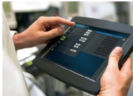
Drahtlose Maschinenbedienung erfüllt Safety-Anforderungen – etwa beim MagicShoe von Trumpf oder beim mobilen Industrie-Pad mit Not-Halt-Funktion von Sigmatek.
