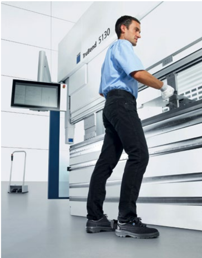
Drahtlose Maschinenbedienung erfüllt Safety-Anforderungen – etwa beim MagicShoe von Trumpf oder beim mobilen Industrie-Pad mit Not-Halt-Funktion von Sigmatek.
