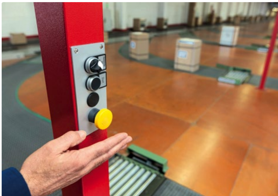
Beispiel für eine Netzwerklösung in der Logistik bei einem Küchenhersteller: Per Energy-Harvesting-Funkschalter meldet der Bediener, dass die Kommission auf einer Staustraße entladen wurde.
