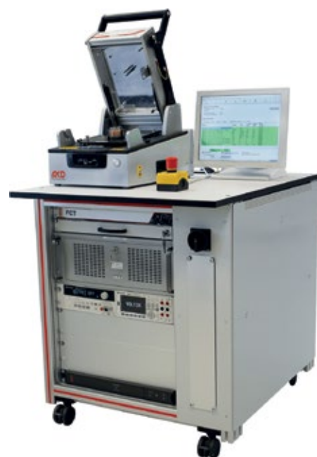
MCD Prüfstand für die Steuerelektronik vom Pumpenmotoren im fahrbaren 19-Zoll-Rack bei geöffnetem Adapter
