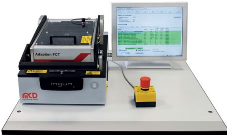
Prüfvorgang der zu testenden Heizungs- und Brauchwasserpumpenmotor- Steuerung im passenden, geschlossenen Adapter
