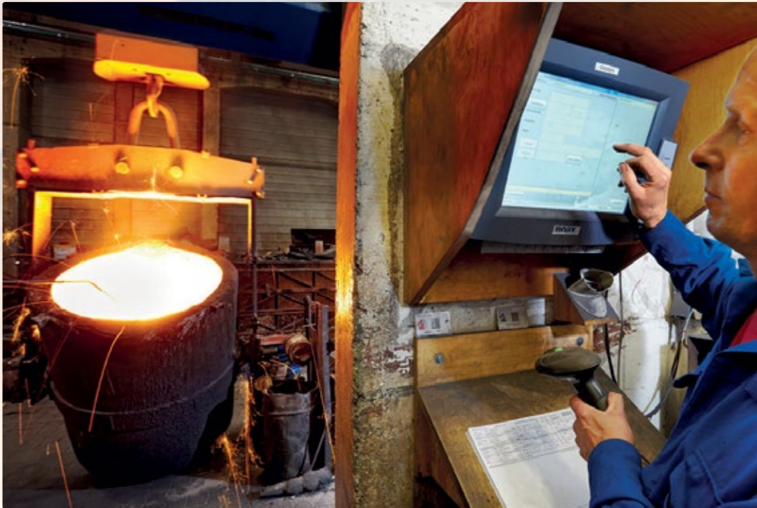
Die in der Gießerei eingesetzten Industrie-PCs von Noax halten hohen Temperaturen, Staub und Funkenflug stand.
