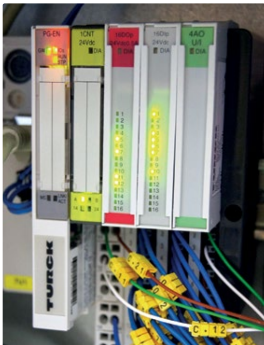
ISW programmierte die Steuerung der gesamten PALC unit mit Codesys auf dem Turck-BL20-Gateway.
