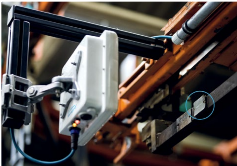
RFID-Transponder ermöglichen automatisches Identifizieren auch dort, wo das Scannen von Barcodes nicht möglich ist.
