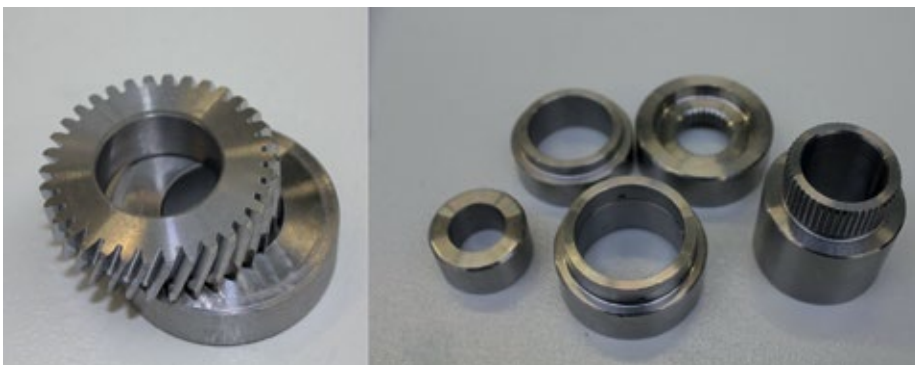
Bearbeitet und unbearbeitet: Planetenräder für 9-Gang-Automatikgetriebe mit verschiedenen Formen und Kantenlängen
