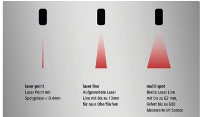
Unterschiedliche Strahlformen ermöglichen eine vielfältige Distanzmessung.
