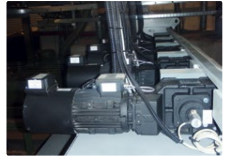
Die Kegelstirnradtriebmotoren erzeugen die Hubbewegung des Kreissägeblatts.
