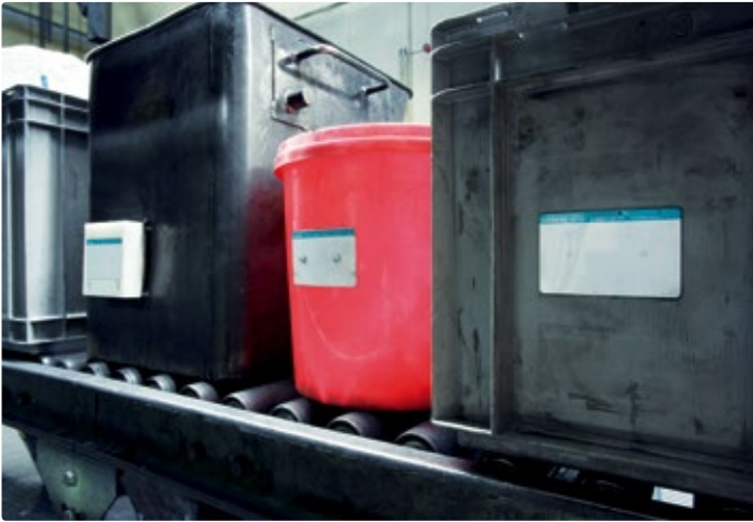
RFID-Datenträger können an Behälter genietet werden. Siemens bietet zudem auch Transponder, die direkt auf Metall angebracht werden können.
