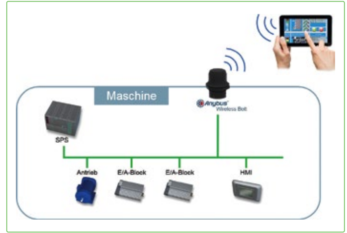
Das Tablet greift über den Anybus Wireless Bolt auf den Webserver der SPS zu.
