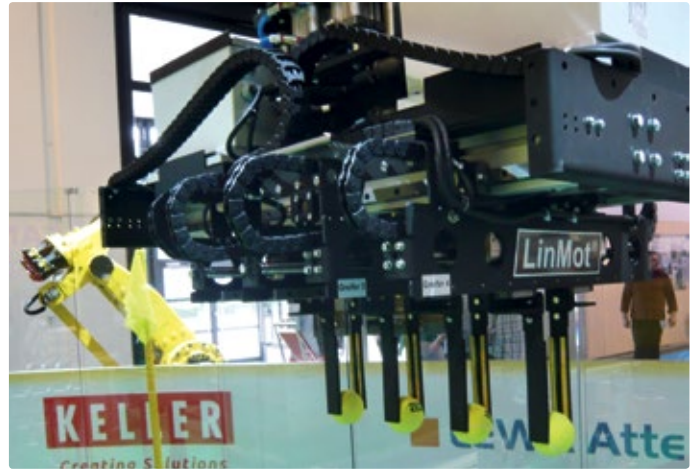
Der LinMot-Linearmotor PS01-37Sx120-HP-N aus der PS01-Serie benötigt wenig Platz und zeichnet sich durch einen großen Hub und eine hohe Maximalkraft aus.
