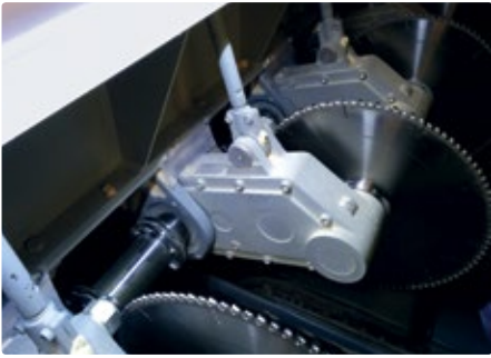
Die innovative Getriebschwinge bringt Vorteile in Sachen Verschleiß und Wartung.
