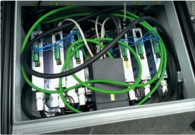
Die Ansteuerung der Linearmotoren übernehmen besonders kompakte und leichte Servoregler von LinMot mit Profinet-Schnittstelle.
