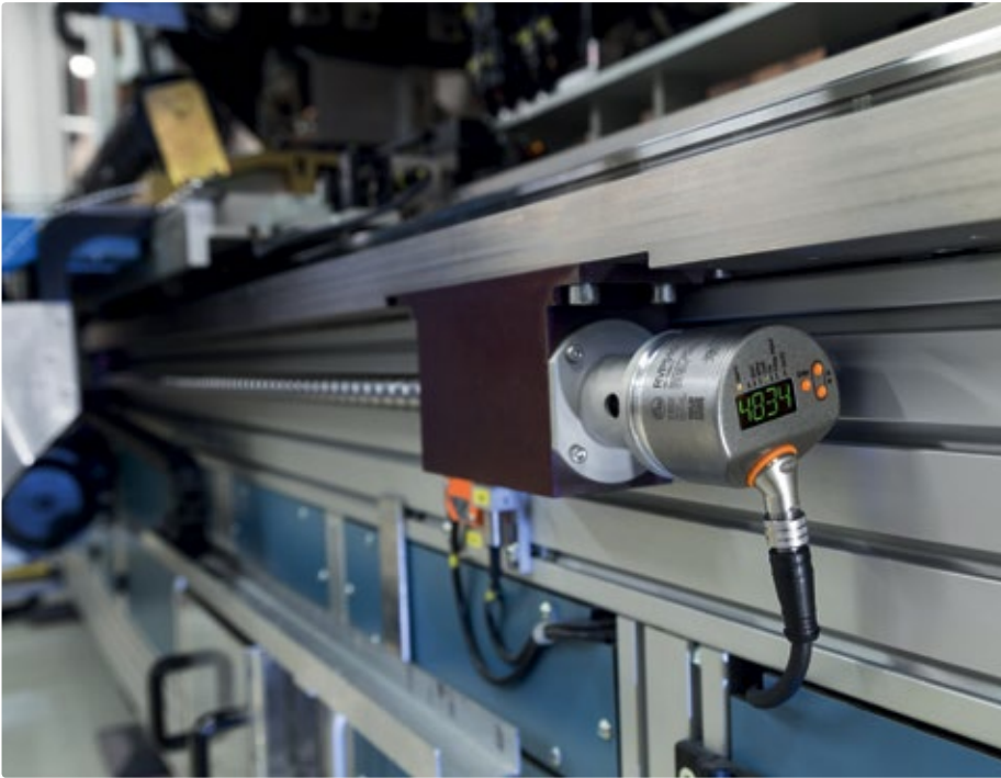
Neben einer IO-Link-Schnittstelle verfügen die neuen, magnetischen Drehgeber von Ifm über ein LED-Display, Status-LEDs und drei Tasten. An der Anzeige (hier: grün) erkennt der Maschinenbediener auf einen Blick, dass an der Maschine keine Grenzwerte über- oder unterschritten sind.
