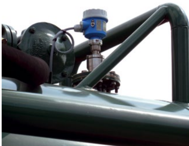
Zuverlässige und sichere Überfüllsicherung von Saugwagen mit dem Füllstand-Grenzschalter Liquiphant FTL5x
