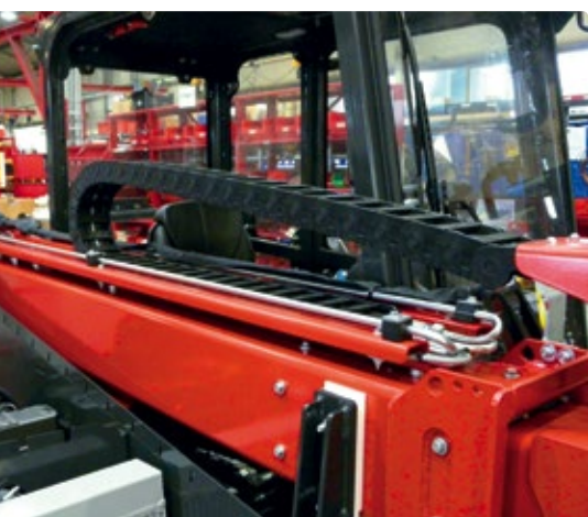
Mit einer Igus-Energiekette kommt die hydraulische Energie über den Teleskopmast zum Anbaugerät.
