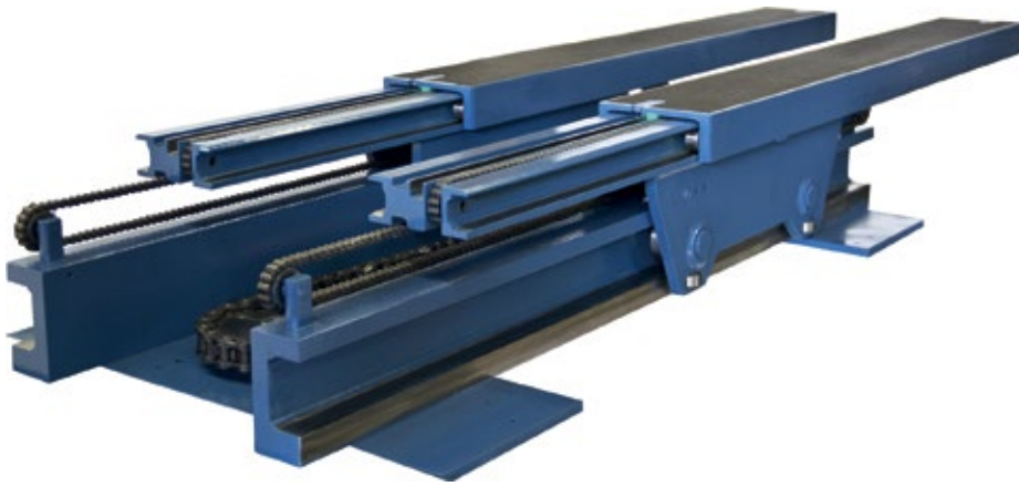
Eine Teleskopgabel besteht aus drei Teilen: dem Grundkörper, dem eigentlichen Teleskop und dem ausfahrbaren Gabelblatt. Pro Gabel verbaut die Römer Fördertechnik 32 Stützrollen.
