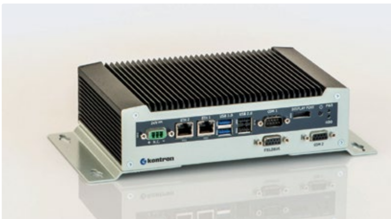
Die Box-PCs sind wartungsfrei. Das heißt: keine Batterie sondern Gold Caps, keine Lüfter, sondern passive Kühlung, keine rotierende Massenspeicher, sondern SSD (Solid-State-Drive).
