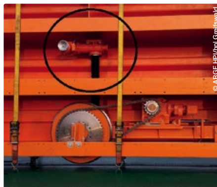
Detailaufnahme des Tores mit dem Spindelhubelement SHE 25 von Pfaff-Silberblau zur Verstellung des Laufrades
