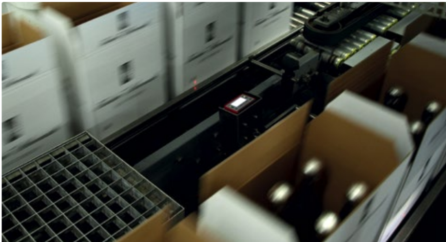
Die Smart-Kameras LSIS 462i lesen die 2D-Data-Matrix-Codes auf den Sektkartons auch bei Geschwindigkeiten von bis zu 6.000 Kartons pro Stunde.
