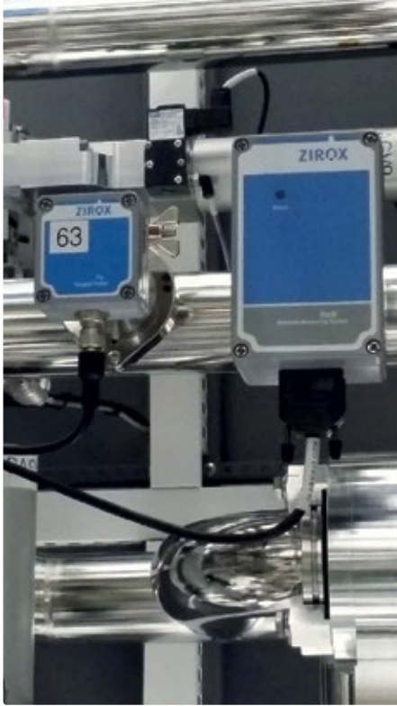
Kombinierter Einsatz einer potentiometrischen O 2 -Sonde (MS27) und einer coulometrischen Keidelmesszelle (HS410) in einer Fertigungsanlage in Südkorea.
