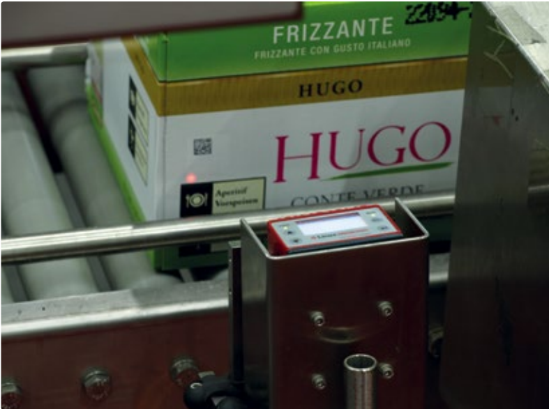
Mit Smart Kameras von Leuze Electronic lassen sich intelligente Kontrollsysteme für die Getränkeindustrie realisieren.
