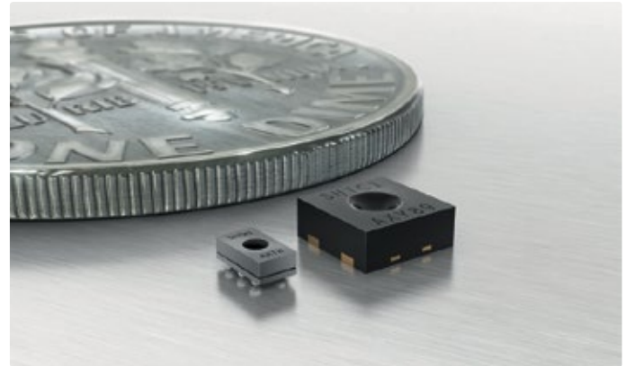
Die Sensoren können durch ihre Baugröße von wenigen Millimetern einfach in die Sitzstruktur integriert werden.
