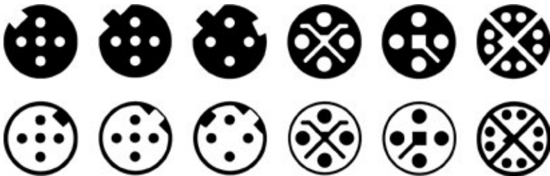
Unterschiedliche M12x1-Codierungen in der Übersicht (oben Kupplung, unten Stecker): A, B, D, S, T, X (v.l.n.r.)
