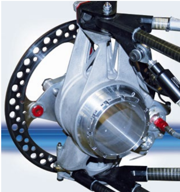
Zwei ungedichtete Schrägkugellager in O-Anordnung aus der Reali-Slim-Dünnringlagerbaureihe von Rodriguez halten den hohen Belastungen, denen sie in der Radaufhängung des Rennwagens ausgesetzt sind, stand.
