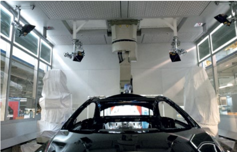
Abb. 1: Mechanischer Aufbau der Beleuchtung
