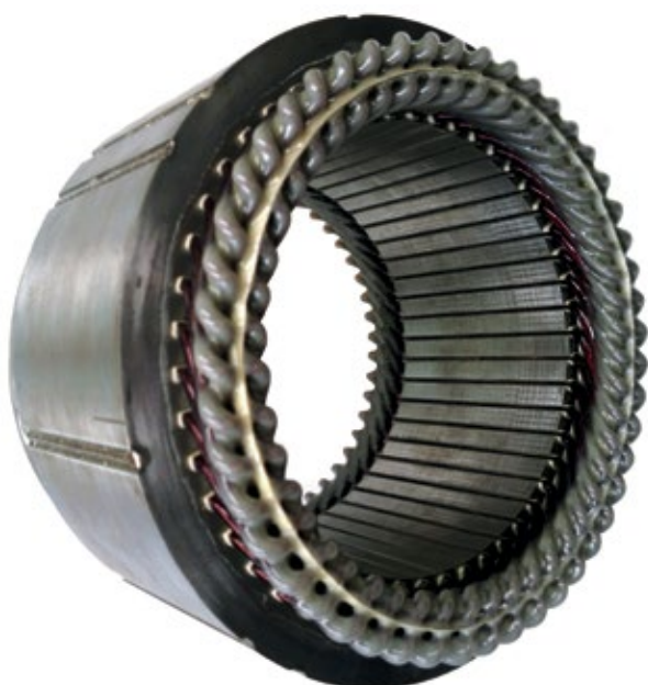
Rechtwinklige Wicklungsdrähte füllen die Wicklungsschlitze des Stators mit bis zu 80 Prozent besser aus als die üblichen Runddrähte. Der Stator ist mit einem besonderen Rotor mit variabler Reluktanzmotorgeometrie kombiniert.
