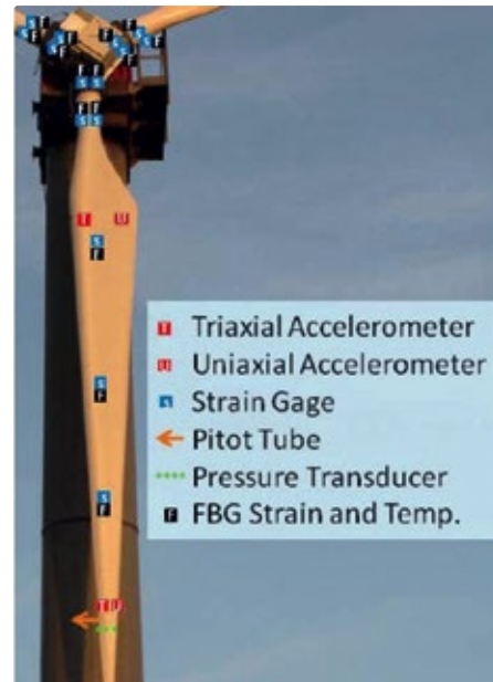
Die Abbildung identifiziert Typ und Position der Sensoren, die am Rotorblatt entlang eingesetzt werden.
