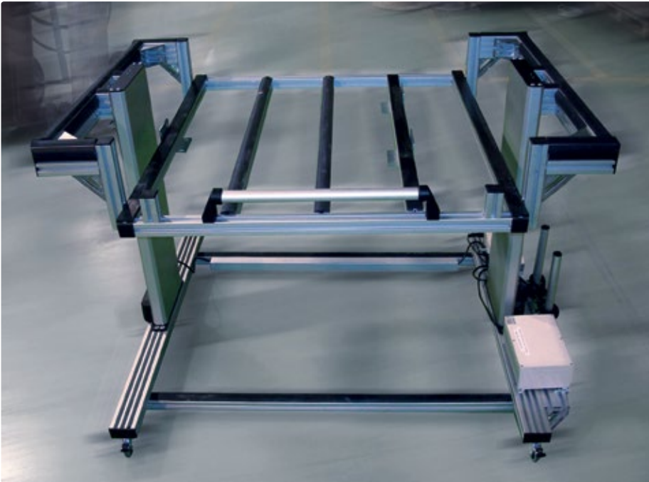
Die elektrische Höhenverstellung des Montagewagens erfolgt über zwei synchronverfahrende Multilift-Hubsäulen und die akkubetriebene Steuerung MultiControl duo.
