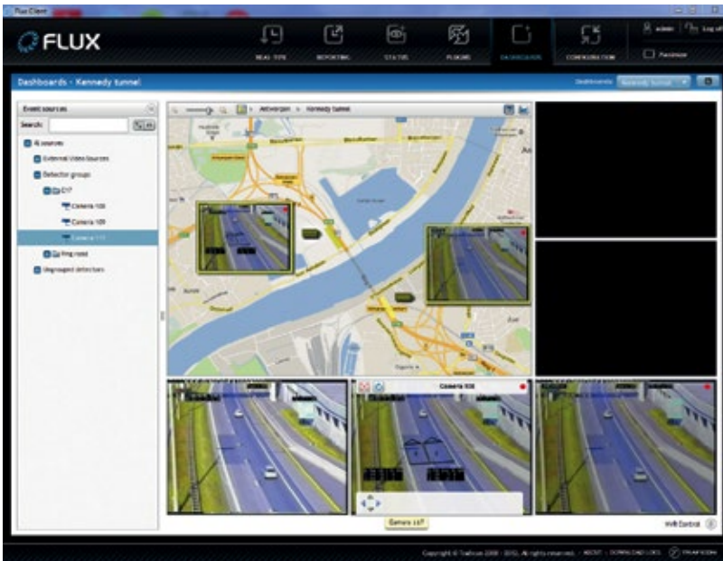
Das Flux-Managementsystem von Flir sammelt und visualisiert Verkehrsdaten, Ereignisse und Alarme von herstellereigenen oder Fremdmodulen.
