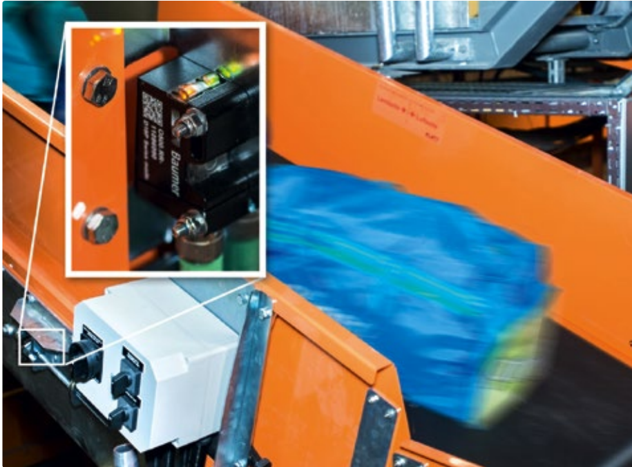
Optische Sensoren erfassen das Gepäck auf der rund zwei Kilometer langen Förderstrecke nach dem Check-in.
