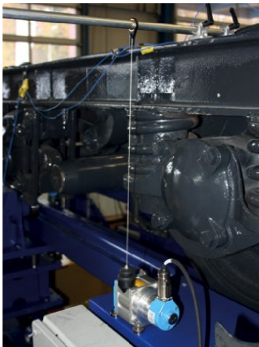
Im oberen Bereich des Drehgestells nehmen Stangen die Seilöse des BFT08 auf. In dieser Messanordnung erfasst der Seilzugencoder die Veränderungen der Federwege, die durch die einwirkenden Kräfte verursacht werden.
