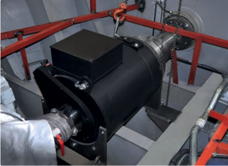
Der High-Torque-Motor ist über die Hohlwelle direkt mit der Antriebswelle verbunden.
