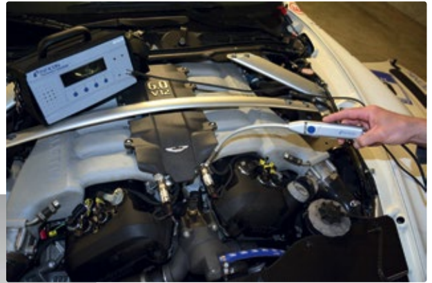
▲ Mobile Dichtheitsprüfung mit der Schnüffelsonde im Motorraum
