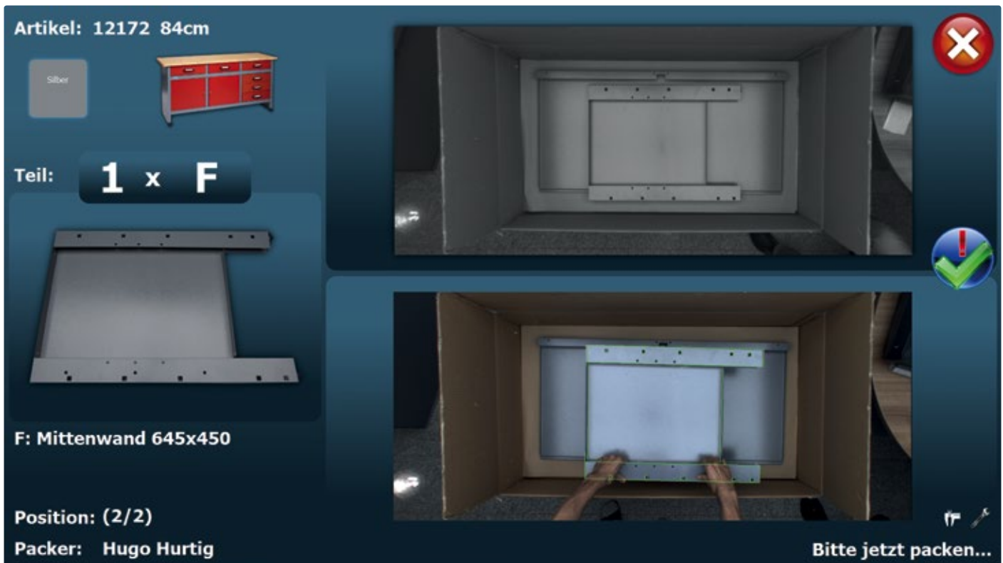
Das System kann den Mitarbeitern nicht nur das jeweils nächste Bauteil anzeigen, sondern überwacht zudem mit Hilfe einer Kamera, dass genau dieser Artikel verpackt wird.
