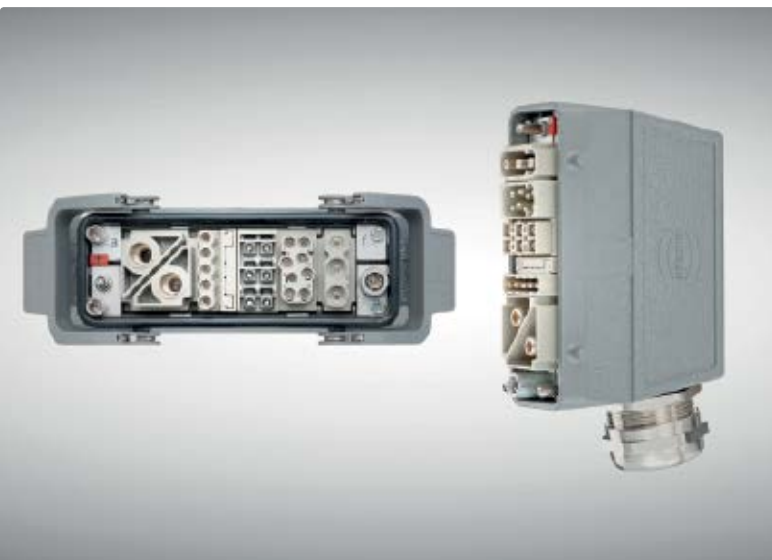
Han-Modular-Steckverbinder für die Übertragung von Leistung und LWL-Signalen (v. l. n. r.): Han-100-A-Axial-Modul (1.000 V), Han-E-Schraubmodul (16 A//230/400 V), Han-LC-Modul (optische Signale, LWL), Han-EE-Quick-Lock-Modul (16 A/400 V) sowie Han-C-Modul (40 A/690 V).
