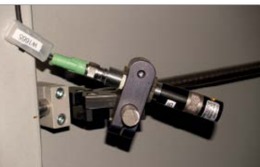
Linienlaser im Detail: Die Beleuchtungen schaffen die Grundlage für die Erfassung der Prüfmerkmale.
