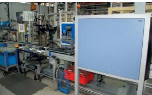
Ein Fördersystem bringt die auf Werkstückträgern montierten Bremsen in die Prüfkabine.
