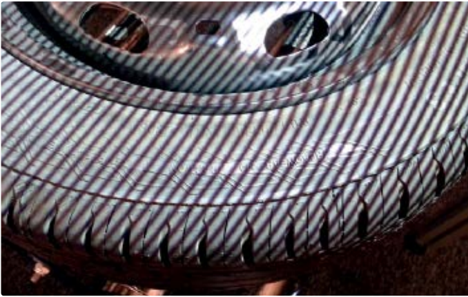
Das System IdentityControl TID 8303.I ermittelt den DOT-Code auf der Reifenflanke und erfasst weitere alphanumerische Informationen an der Seitenwand eines Reifens.
