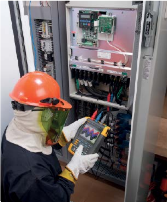
Mit dem tragbaren Fluke ScopeMeter der Serie 190 II lassen sich Einschaltströme über den gesamten Zyklus erfassen und anzeigen.
