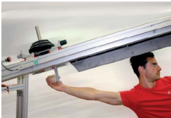
Der magnetostruktive MK4-Sensor auf der Führungsschiene codiert die Position des Schlittens während der Wurfbewegung durch ein analoges Spannungssignal, das über einen AD-Wandler von einem PC registriert und ausgewertet wird.
