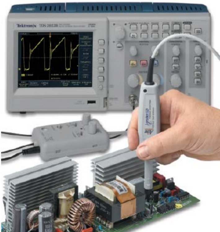
Der Stromteastkopf I-Prober 520 misst Ströme durch einfaches Aufsetzen der Prüfspitze. Dafür muss weder der Stromkreis unterbrochen, noch ein Messwiderstand eingebracht werden.
