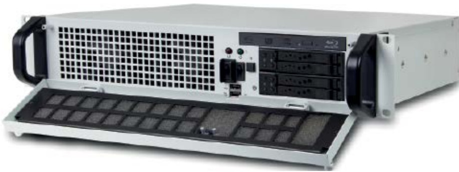
Das 19"-System 9612380-MBQ87 mit Intel-Core-Prozessor der vierten Generation adressiert den High-End-Markt.
