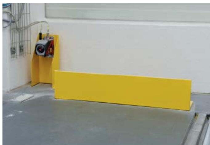
Die Positionierung des Umsetzwagens übernimmt das Laser-Distanzmessgerät AMS 300i.
