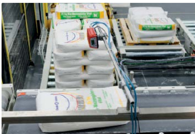
Die Barcodeleser können die aufgespritzten Barcodes in den relativ unterschiedlichen Positionen auf den Stärkemehlsäcken sicher lesen.
