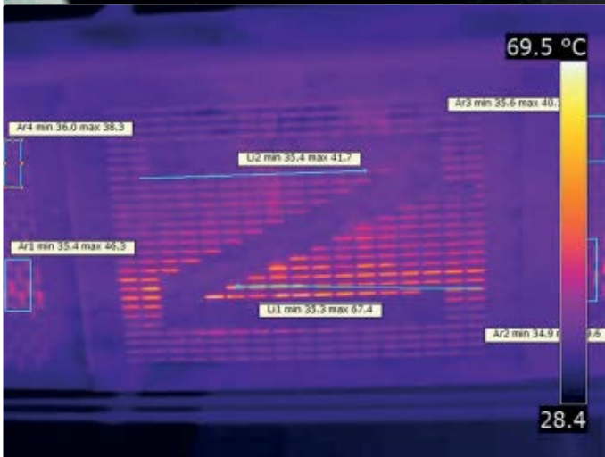
Das Wärmebild zeigt, dass der durchschnittliche Temperaturunterschied zwischen den zwei Leitungsgruppen bei rund 5 °C liegt, mit Spitzenwerten von über 15 °C.
