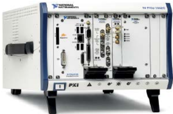
PXI-Chassis mit acht Steckplätzen
