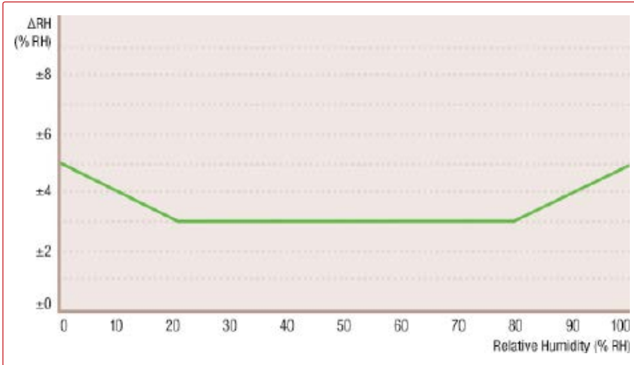
Bei 20 bis 80 Prozent relativer Luftfeuchte erreicht der Feuchte- und Temperatursensor von Sensirion eine Genauigkeit von \pm 2 Prozent.
