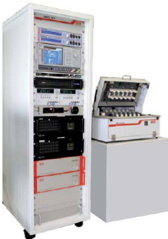
Neben dem Test-Rack des UMTS-Modul-Testplatzes befindet sich der MCD-Universaladapter, der sechs Prüflingen aufnimmt. Oben im 19-Zoll-Rack sieht man den neuen Audio Analyzer.
