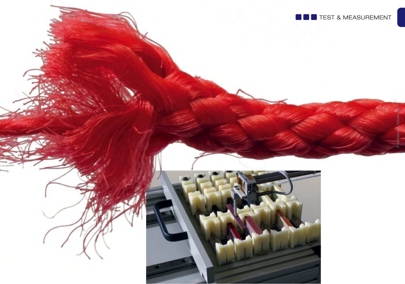
Der Roboter entnimmt eine Komposit-Probe aus dem Magazin für einen Biegeversuch.
