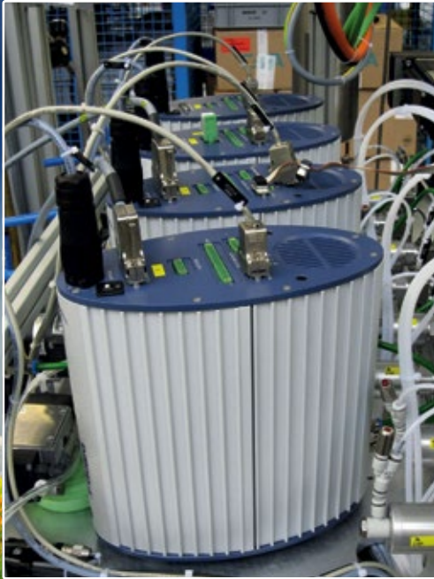
Im Gegensatz zur klassischen Helium-Dichtheitsprüfverfahren sind die T-Guard-Systeme kompakter, günstiger und einfacher in die Anlagen zu integrieren – kommen sie doch ganz ohne Vakuumkammer und Massenspektrometer aus.
