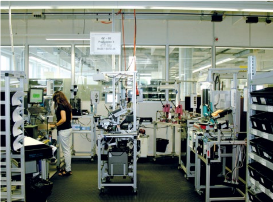
Aktuell werden täglich 200 NextGen-Sensoren O500 und O300 nach dem Prinzip One-Piece-Flow auf einer Linie hergestellt.
