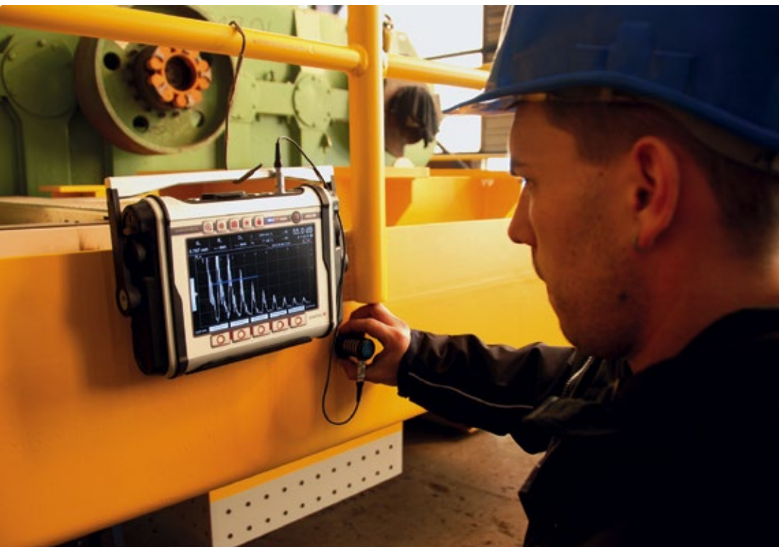
Trotz seiner kompakten Maße verfügt das ST10 über ein hochauflösendes 8-Zoll-Grafikdisplay im Format 16:9, das alle Werte und Messkurven so groß wie möglich anzeigt.
