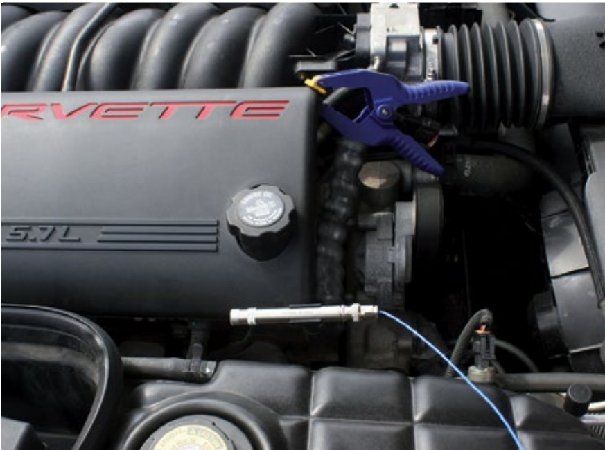
Eine Mikrofon-/Verstärkerkombination für Temperaturen bis 120 °C detektiert Geräusche im Motorraum.
