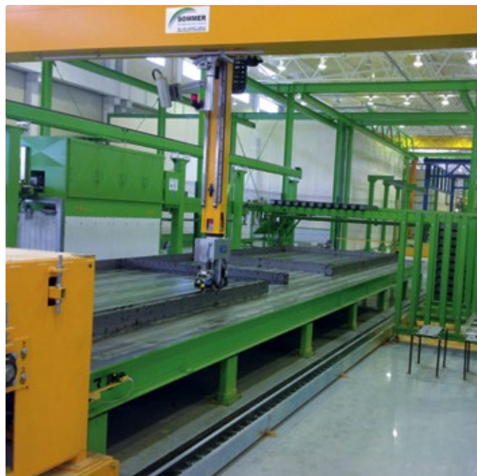
Der Multifunktions-Schalungsroboter der Sommer Anlagentechnik positioniert die Schalungen mit hoher Präzision und gibt damit die Form für die Beton-Fertigteile vor.
