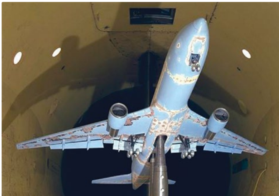
Für aeroakustische Untersuchungen eignen sich piezoelektrische Aufnehmer.
