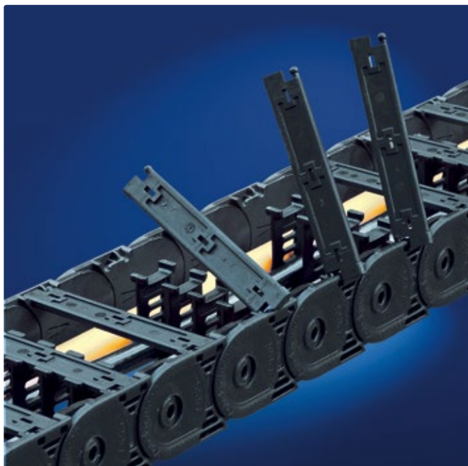
Dank der Kugelgelenkmechanik können die Bügel schnell nach außen aufgeklappt und gelöst. Auf diese Weise lässt sich die Kette schnell öffnen.
