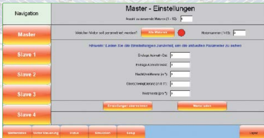
Parametrieroberfläche der Steuerung des Solarpark Postbauer-Heng (siehe Aufmacherbild) mit 1-Achs-Nachführsystemen.
