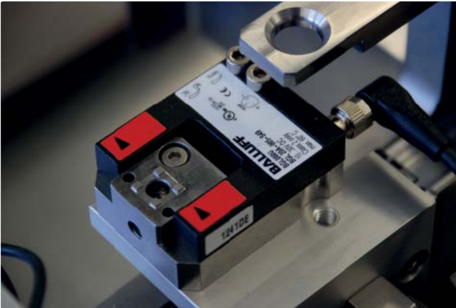
Eine Gabellichtschranke mit Pinpoint-LED sorgt dafür, dass der Montageprozess nur dann beginnt, wenn das passende Teil in der Halterung sitzt.
