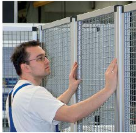
Einfache und schnelle Montage: Rahmen in die untere Halterung stecken, leicht anheben und in die obere Halterung drücken – fertig!
