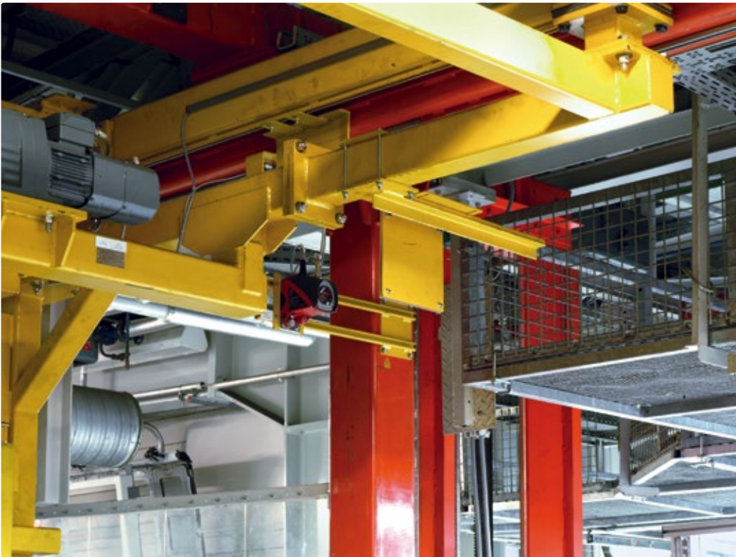
Umsetzer mit fest montiertem Messgerät und Reflektor an der beweglichen Einheit.
