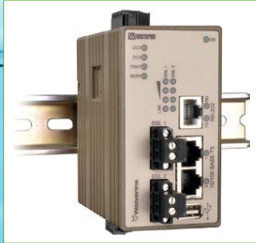
Durch die 1:1-NAT-Funktion können Windräder mit der gleichen IP-Adresse angesteuert und eindeutig identifiziert werden.
