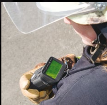
▲ War 2009 Gewinner beim GIT SICHERHEIT AWARD und ist Standardausrüstung für viele Überwachungsaufgaben: 7-Gas-Messgerät Microtector G460 – hier im Einsatz bei der Feuerwehr
