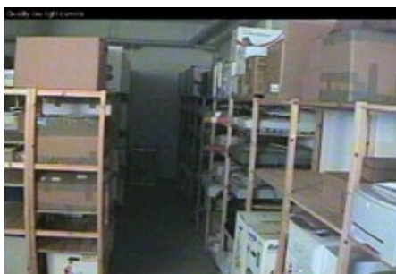
„Lightfinder“-Technologie: Details selbst bei 0,5 lux erkennbar
