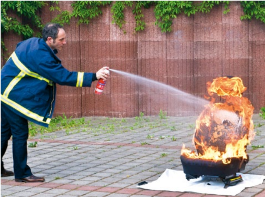
Sprühdauer von 25 Sekunden, Abstand zur Brandquelle vier Meter: Auch Experten von der Feuerwehr bescheinigen dem System die Tauglichkeit
