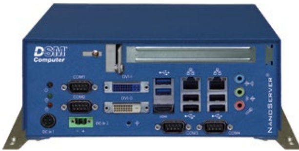
Abb.1: Der NanoServer N1-QM67 ist trotz seiner geringen Baugröße für eine Betriebstemperatur bis 50 °C spezifiziert.
