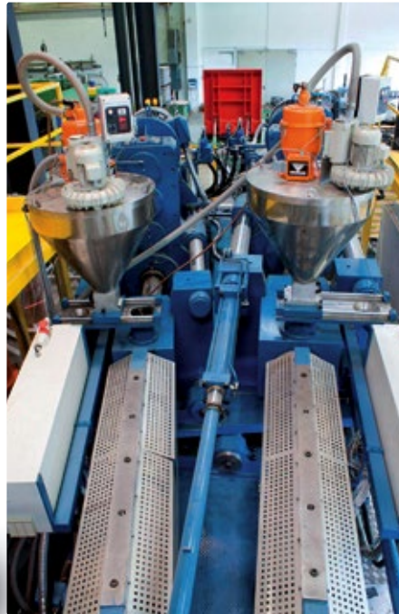
Die Tandemspritzeinheit verfügt über zwei Antriebe mit einer Motorleistung von 120 und 200 kW.
