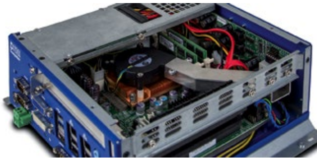
Abb. 2: Zwei Lüfter sorgen im Inneren des N1-QM67 für eine optimale Kühlung.
