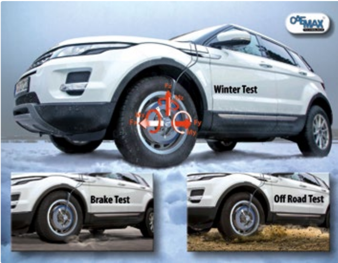
Die neuen Messräder WFT-C x von Caemax erlauben die Fahrzeug-Erprobung jetzt bei jeder Witterung und unter harten Einsatzbedingungen.
