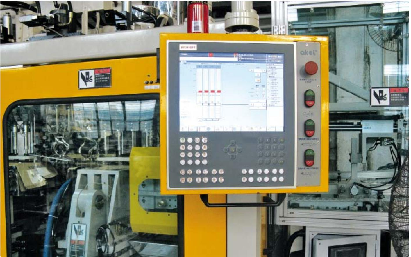
Der Blowmolding-Panel-PC CP6202-1026-0010 stellt alle Funktionen zur Verfügung, die der Nutzer für die Bedienung benötigt.
