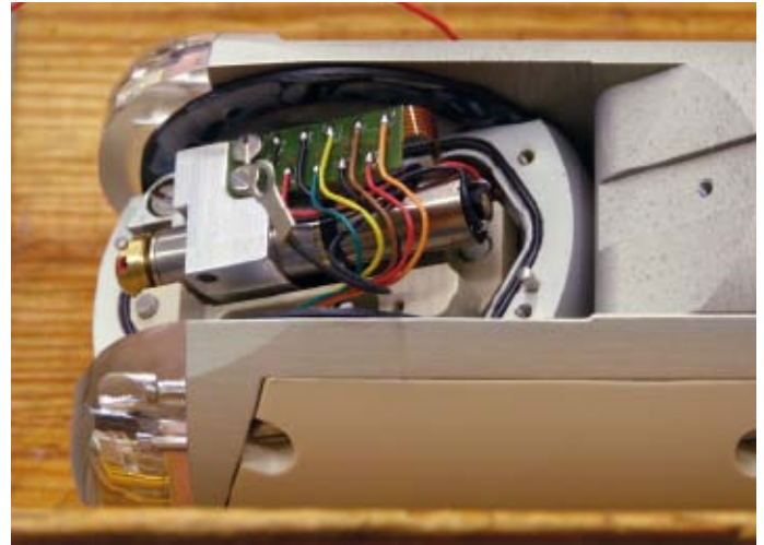
Die Kleinstantriebssysteme eignen sich ideal für die optische Fokussierung.
