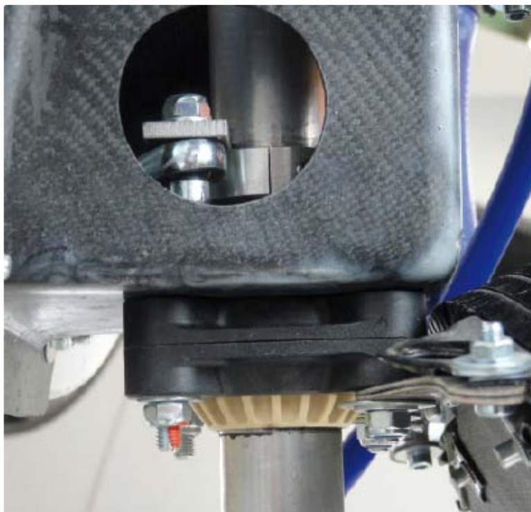
Ein Igubal-Flanschlager der Baureihe KFSM leitet die Kräfte, die das Bugrad beim Landen aufnimmt, in den Flugzeugrumpf ein.
