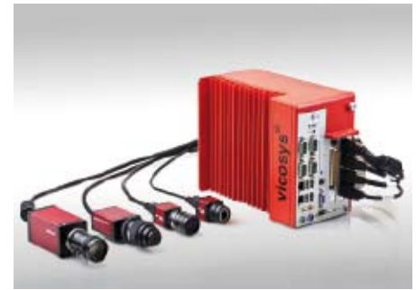
Kombination von sichtbarer und thermischer BV durch Anschlussmöglichkeit von Infrarot-Kameras
