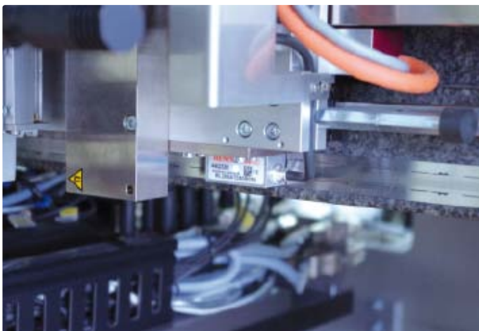
Eine farbige LED zeigt die sichere Funktion der Messwerterfassung und vereinfacht damit die Inbetriebnahme und Überwachung während des Betriebs.
