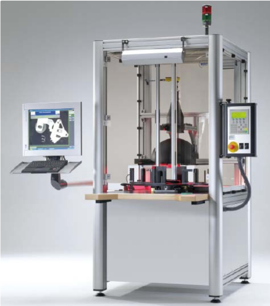
Das Vision-System prüft die Bauteile der Kabeltrommel auf Vollständigkeit, exakte Lage sowie die Funktionsmaße nach der Montage.
