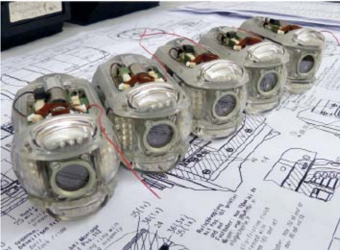
Der kompakte Kamerakopf Orion wird über drei Kleinstantriebe bewegt.
