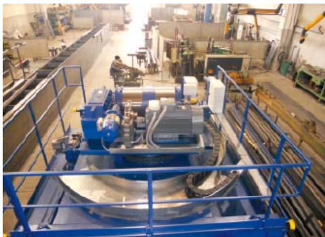
◀ Im Lager eines Stahlwerks wird zum Transport der Materialien ein Windenwagen eingesetzt: Das rundlaufende System wurde mit einer auf der Seite liegenden Energieführungskette gelöst.
