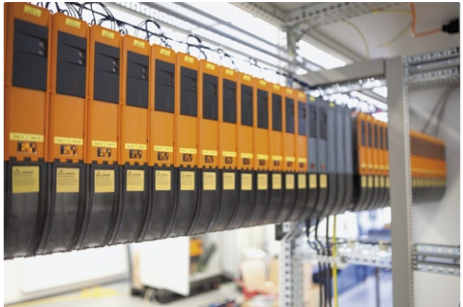
398 Acofos-Module sorgen durch präzise Synchronisation mit Powerlink für die Ansteuerung der Kluppen.
