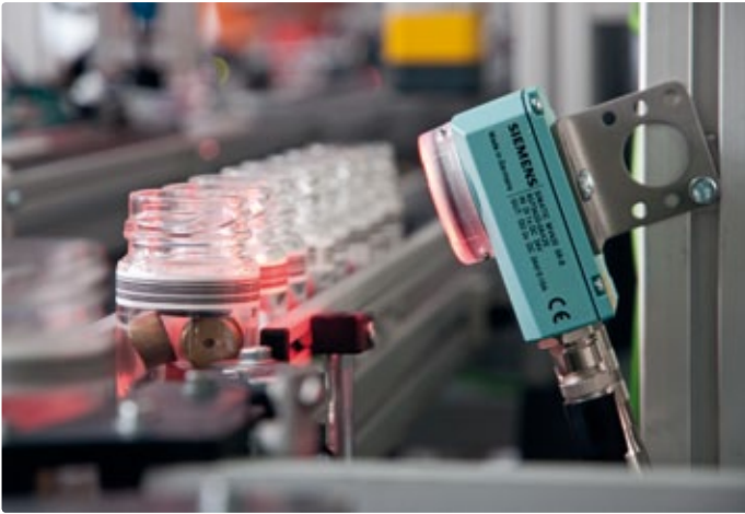
Für Objekte mit Label, wie etwa kleine Glasflaschen, ist meist die optische Kennzeichnung das Mittel der Wahl, da die Markierung auf dem bereits vorhandenen Etikett erfolgen kann.
