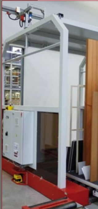
Die Positionierung der Transferwagen übernehmen Barcode-Positioniersysteme BPS 37, die Kommunikation erfolgt kontaktlos und verschleißfrei mit Datenübertragungslichtschranken DDLS 200.
