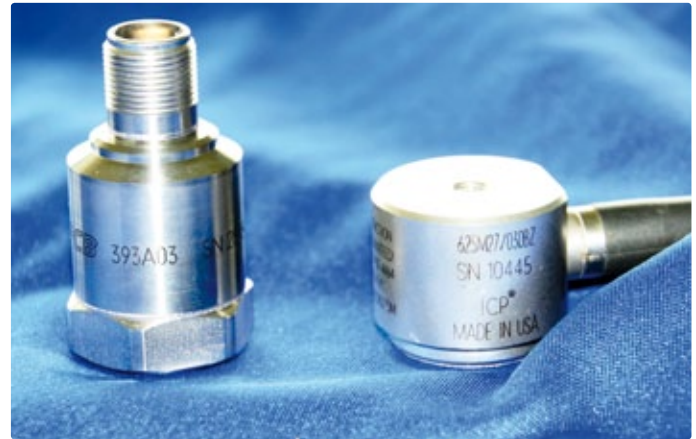
Schwingungs-Aufnehmer detektieren die Veränderungen der Fundamente.
