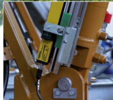
Der Sensor eignet sich für den harten Einsatz am Fahrgeschäft: kurze Blindzonen, IP67 und störsicherer induktiver Positionsgeber.
