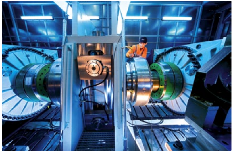
Drehmomentmessflansch Typ T10FM mit Nenndrehmoment im Rexroth-Prüfstand (Werksbild Bosch Rexroth/Witten)
