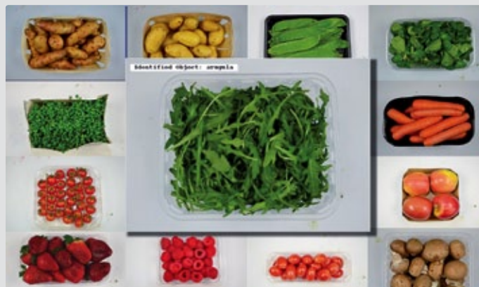
Mit der samplebasierten Identifikation kann aus unterschiedlichen Objekten ein ganz bestimmtes Produkt, das dem System bekannt sein muss, erkannt werden.
