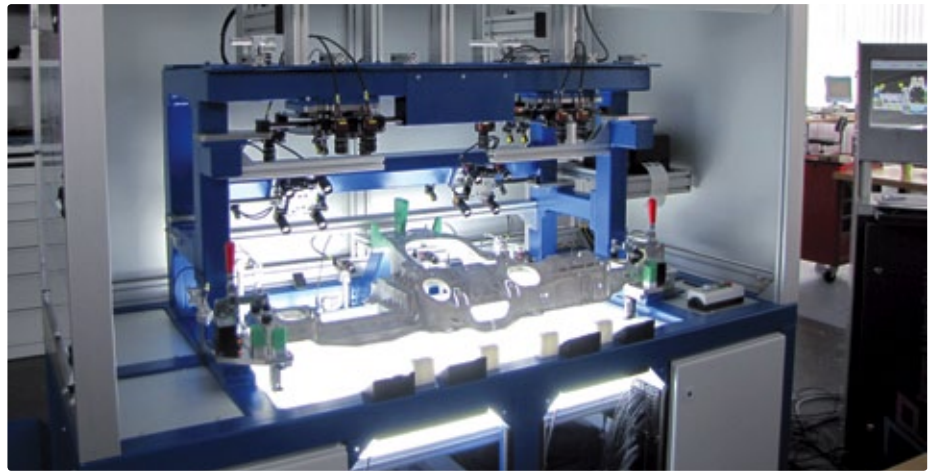
Da durch die Anordnung von Prüfobjekt und Kameras sowie den Einsatz von Hintergrundbeleuchtung und Umlenkspiegeln auf das Wenden des Trägers verzichtet werden kann, ist eine präzise 3D-Messung möglich.
