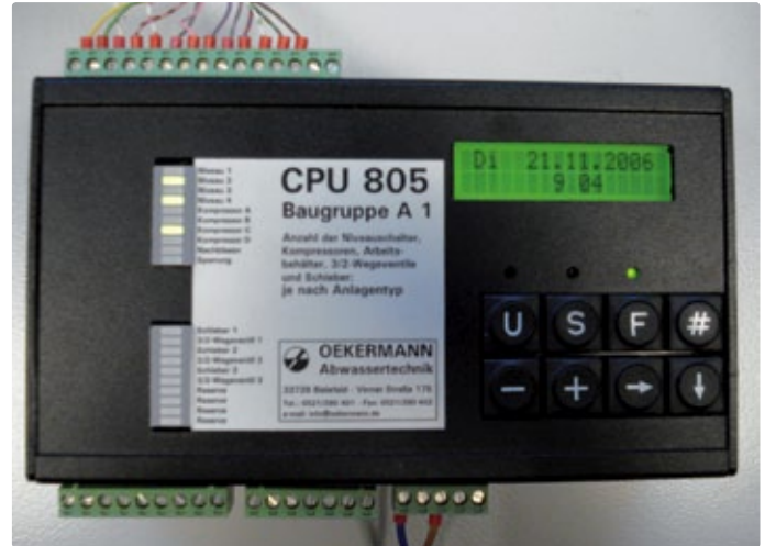
Die elektronische Steuerung CPU 805 ist eine Eigenentwicklung von Oekermann. Die Komponenten und Baugruppen stammen vom Bremer Distributor Distrelec Schuricht.
