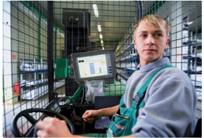
Der IPC auf dem Gabelstapler unterstützt bei der Erfassung der Logistikkdaten.
