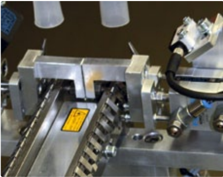
Je ein Lichttaster mit Hintergrundausbildung vom Typ FT 10 pro Förderbahn prüft die Anwesenheit von Metallklammern an einem Vibrationsförderer. Um die Kante jeder Klammer unabhängig von ihrer genauen Position zuverlässig zu erfassen, wird hier die Tastervariante mit länglichem Lichtfleck eingesetzt.
