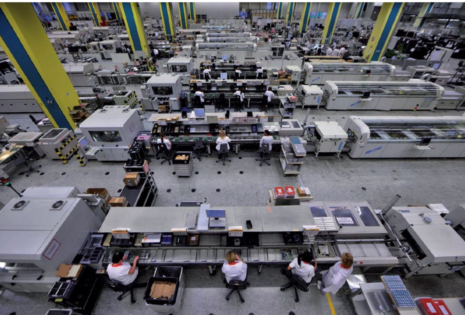
Die hochautomatisierte Mainboard-Fertigung am Fujitsu-Standort Augsburg ermöglicht Qualitäts- und Kostenvorteile gegenüber einer Fertigung in Asien.
