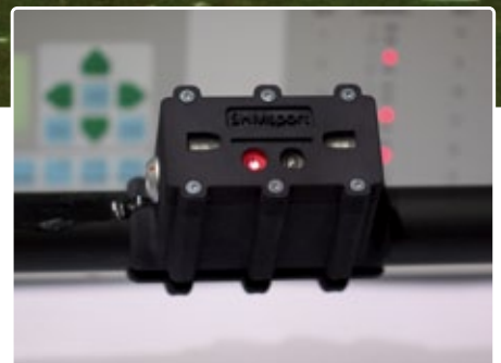
Am Paddel montiertes Monitoring-System
