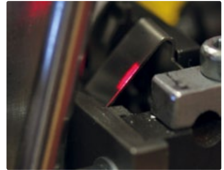
Je ein Lichttaster mit Hintergrundausbildung vom Typ FT 10 pro Förderbahn prüft die Anwesenheit von Metallklammern an einem Vibrationsförderer. Um die Kante jeder Klammer unabhängig von ihrer genauen Position zuverlässig zu erfassen, wird hier die Tastervariante mit länglichem Lichtfleck eingesetzt.
