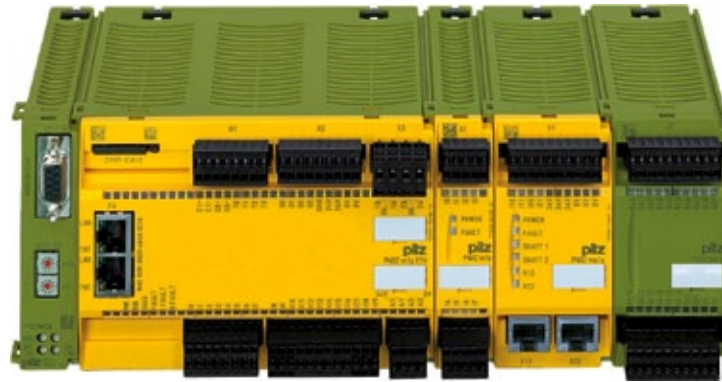
Das konfigurierbare Sicherheitssystem PNOZmulti ist für Anwendungen bis Performance Level e und Safety Integrity Level (SIL) CL 3 geeignet.
