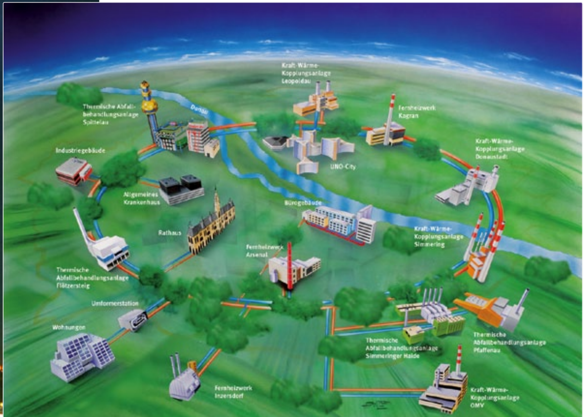
17 Anlagen sorgen für Wärme in einem 1.150 km umfassenden Verbundnetz im Großraum Wien.
