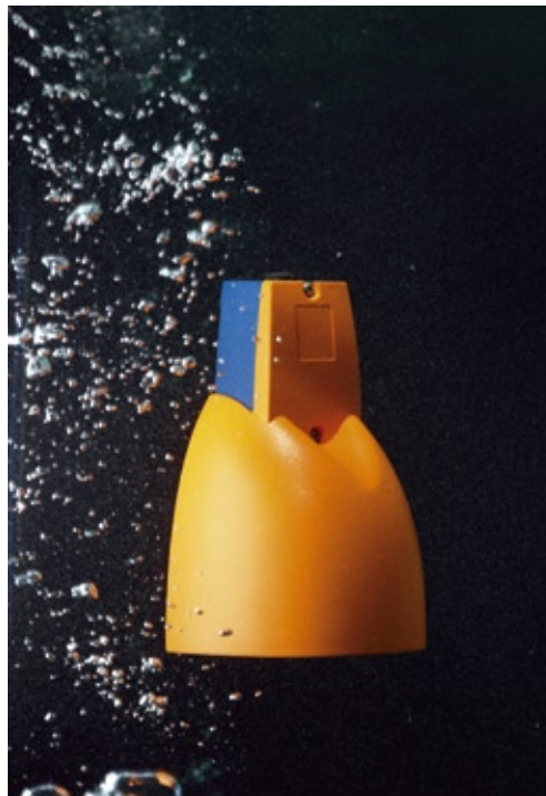
Schalter auf Tauchstation: Im steute-Labor wird ein Fußschalter geprüft, der Schutzart IP 68 erreicht.
