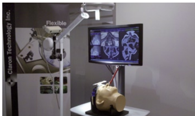
Durch das Tracken mehrerer Xpoints lässt sich die Positionierung des chirurgischen Instruments in sechs Freiheitsgraden ermitteln.
