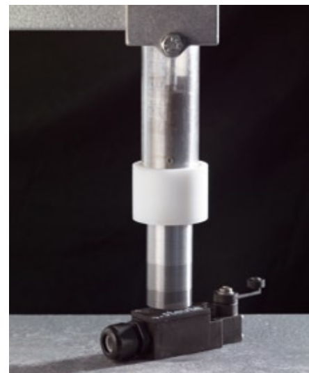
Ein Schlagtest nach EN-Norm ermittelt die mechanische Festigkeit von Schaltgeräten für explosionsgefährdete Bereiche.
