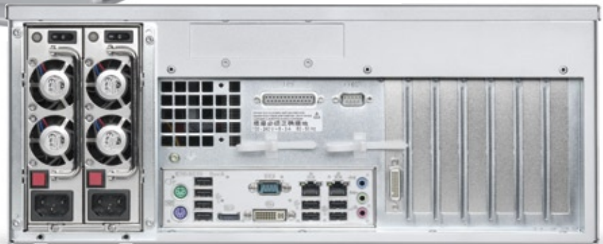
Rückansicht des IPC547C. Der Rack-PC verfügt über sieben lange Erweiterungssteckplätze und eine Vielzahl an Onboard-Schnittstellen.
