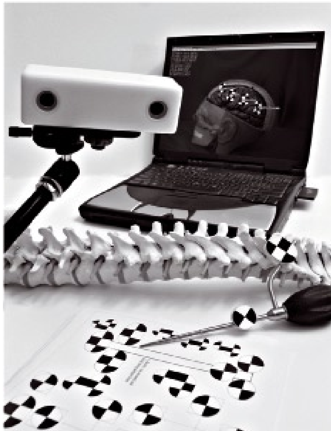
Der MicronTracker: Die Stereovision-Kamera ermittelt und verfolgt die Positionierung und Orientierung von Markern.
