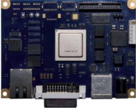
Die einfache Migration von x86er auf ARM: Geplantes Kontron Motherboard im Pico-ITX Formfaktor mit Nvidia Tegra 2
