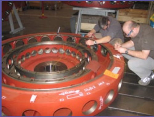
Applikation der DMS-Messstellen am Tragring (Durchmesser: 1.320 mm) für die Ventilatorschaufeln im Kraftwerk Zolling.
