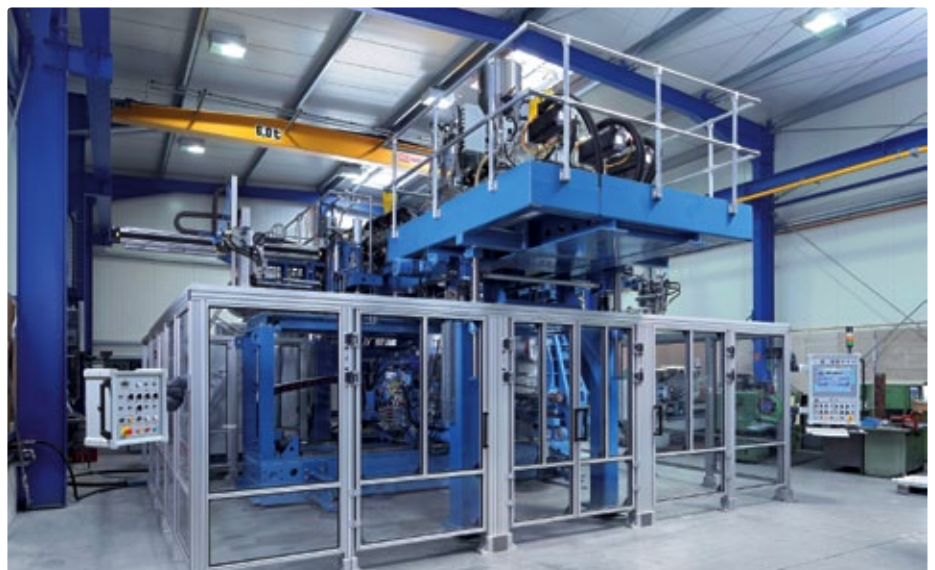
Auf der Doppelmaschine mit zwei Schließeinheiten, der TBA 300 D von MBK Koetke, werden künftig Tanks aus Kunststoff für Schneemobile und Quads gefertigt.
