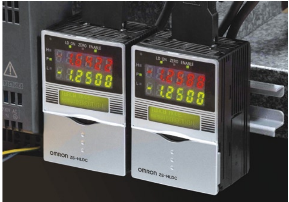
Abb. 2: Bei den Qualitätssicherungsanlagen für Solarzellen vermessen sechs Sensorköpfe, also jeweils drei Sensorpaare die Dicke und Verbiegung. Jeder dieser Sensoren ist mit einem scheckkartengroßen volldigitalen Sensorcontroller kombiniert, der die aktuell gemessenen Daten anzeigt. Hier lassen sich auch die Abstandssensoren entsprechend der jeweiligen Applikation parametrieren.
