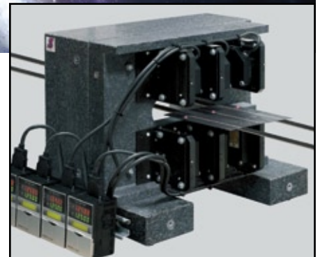
Abb. 1: System zum Vermessen von Solarzellen. Die Solarzellen bewegen sich auf zwei Bändern durch drei Sensorpaare hindurch. Für die einfache Montage und Justage sind die Sensoren auf einer Hartgesteinplatte angebracht.
