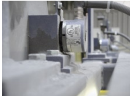
Abb. 3: Da die Drehgeber völlig offen angebracht sind, müssen sie besonders unempfindlich sein. Kein Problem für Wachendorff-Geräte, die außergewöhnlich robust sind.
