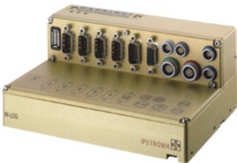
Abb. 3: M-LOG-Modul von Ipetronik ist eine PC-Datenloggerplattform zur autarken Datenerfassung. Der Logger kann durch verschiedene Karten und externe Komponenten modular konfiguriert und erweitert werden. Neben den physikalischen Messeingängen lässt sich M-LOG optional mit entsprechenden Kommunikationsprotokollen bestücken.
