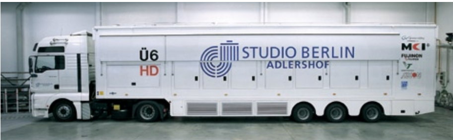
Abb. 5: 40 t Technik: HDTV-Übertragungswagen Ü6 von Grass Valley mit bis zu 25 Kameras, 4-Ebenen-Videomischer mit 62 Eingängen und einem Audiomischer
