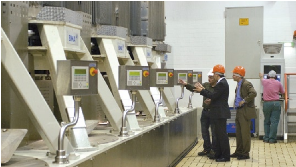
Abb. 3: Die Instandhaltung der Zentrifugen wird anhand von kontinuierlich gemessenen Zustandswerten (Condition Monitoring) geplant und akute Störungen sollen so frühzeitig erkannt werden.
