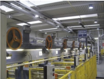
Abb. 4: Wachendorff Geber sorgen für eine konstante Verweildauer in der Glühanlage.
