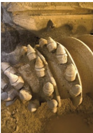
Abb. 3: Der Bohrkopf der Maschine: Auf einer Strecke von 350 km frisst er sich durch das Gestein
