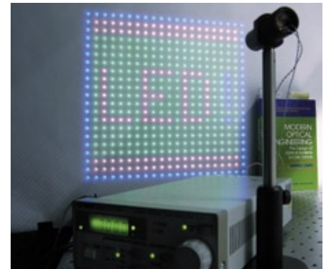
Abb. 3: Labormuster eines Spotarray-Generators mit 21 x 21 regelmäßig angeordneten, individuell eingefärbten Spots
