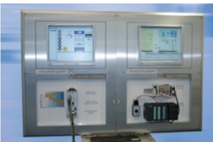
Abb. 3: Testsimulation für fluidtechnische und mechatronische Komponenten sowie Condition Monitoring in einem: die Steuerung der Entwicklungsumgebung der RWTH Aachen
