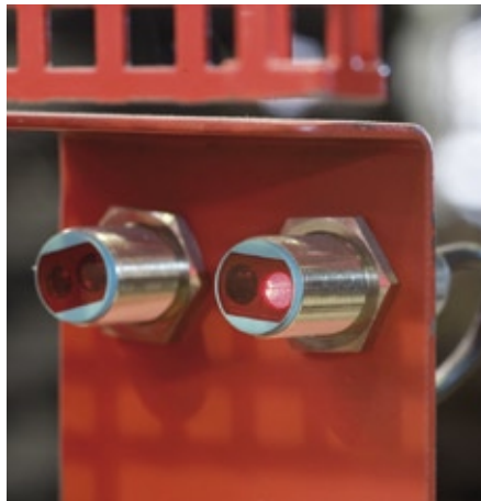
Abb. 1: Noch ist die Sicht gut: In einer Gießerei werden optoelektronische Sensoren häufig durch Staubablagerungen in ihrer Funktion beeinträchtigt. Daher werden die Geräte hier gerne redundant aufgebaut.
