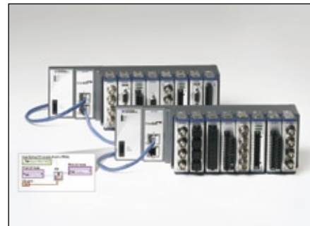
Abb. 3: Die CompactDAQ-Chassis cDAQ-9174 und cDAQ-9178 eignen sich für Datenerfassungssysteme, die verschiedene Signale erfassen. Einen detaillierten Rückblick zum VIP-Kongress 2009 und seinen Inhalten finden Sie unter www.ni.com/german/vip .
