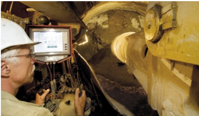
Abb. 2: Nur wenige Meter hinter dem sich in das Gestein fressenden Bohrkopf sitzt der Maschinenführer vor seinem noax Industrie-PC.
