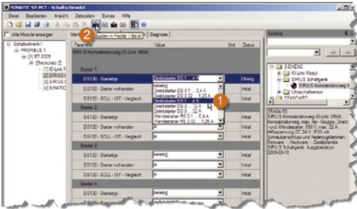
Abb. 3: Das Port Configuration Tool (S7-PCT) importiert komfortabel die Geräte-IODD und stellt damit eine einfache, übersichtliche Parametrieroberfläche zur Verfügung.
