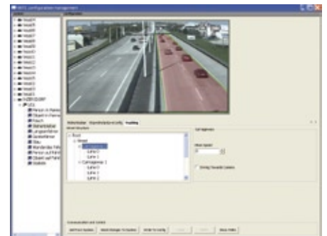
Abb. 3: Die Videobilderkennung erfolgt mittels Softwaremodulen, die anforderungsgerecht zusammengestellt werden können.
