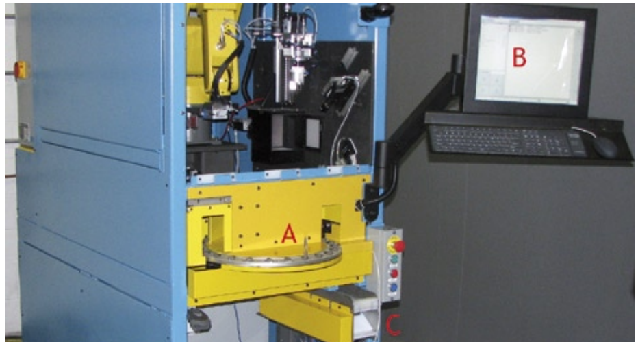
Abb. 1: Das Karussell, das die Teile hält, liegt im vertikalen Zentrum des INL-1900x2T (A). Die Bedienoberfläche und die Ergebnisse der Inspektion werden auf dem Monitor angezeigt (B). Fehlerhafte Teile werden über die Rutsche an den Operator zurückbefördert, so dass sie toleranzmäßig überarbeitet werden können (C).
