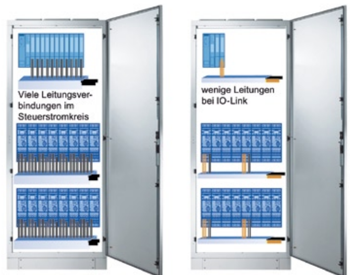
Abb. 2: Die parallele Verdrahtung des Steuerstromkreises bei mehreren Schaltgeräten erfordert viele EA-Module (Schrankschrank links). Mit IO-Link und einer cleveren Gruppenbildung reduziert sich sowohl der Platzbedarf (Footprint) im Schaltschrank, als auch die Anzahl der Verdrahtungspunkte (Schrankschrank rechts).
